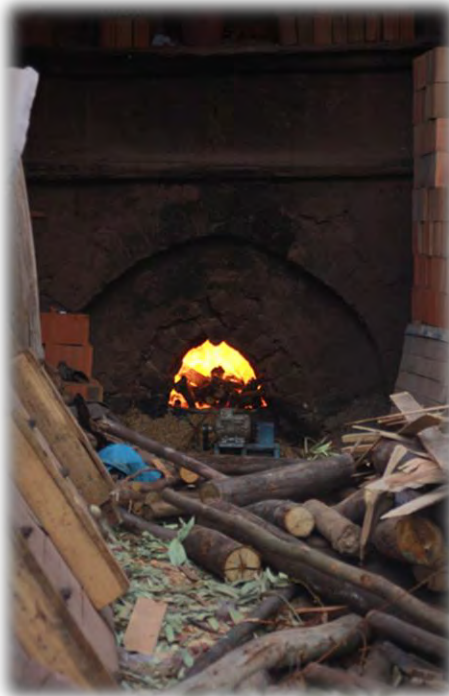
Foto 35: Caldeado de horno artesanal parrillero, empleando el motor para insuflar aire.
