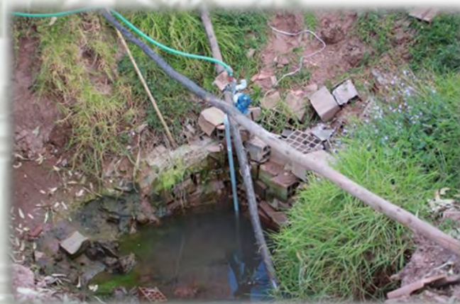
Fotos 20 y 21: Pozos de almacenamiento de agua para preparación de mezcla y moldeado de ladrillos.
