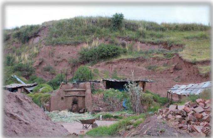
Foto 15: Taller artesanal, horno, ramas como combustible, fuentes de materia prima, no se observa conexión eléctrica.
