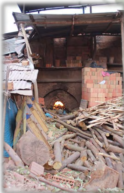
Foto 30: Caldeo de horno parrillero, empleando troncos de eucalipto, restos de listones de madera como combustible.
