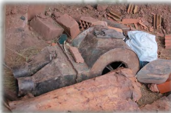
Foto 34: Motor para insuflar aire durante el encendido y caldeo del horno.
