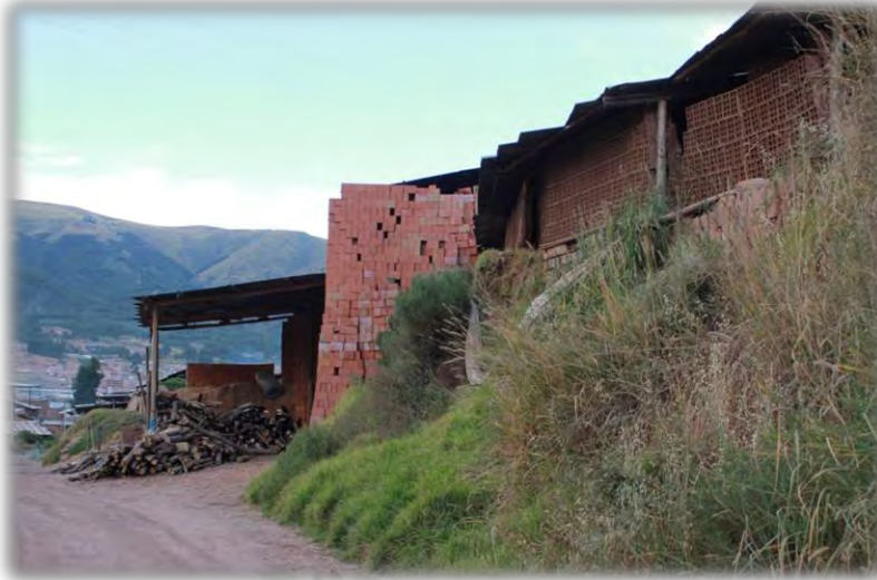
Foto 22: Producción de ladrillos mecanizados listos para la venta. Cubiertos por calaminas, se observan ladrillos preparados para la quema.
