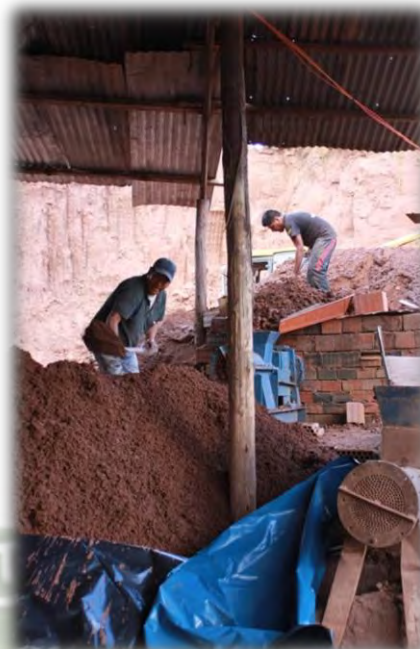
Foto 19: Participación del padre de familia e hijos en la preparación de arcilla, con apoyo de una moledora – mezcladora, se observa conexiones eléctricas.
