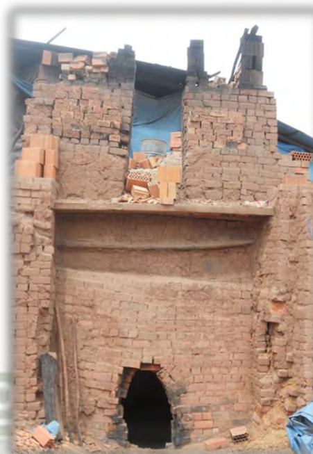
Foto 26: Horno parrillero artesanal con techo de calamina y cubierta de plástico, sin chimenea.
