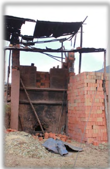
Foto 25: Horno de parrilla artesanal con techo precario de calaminas, sin chimenea, en la parte superior se observa la producción de ladrillos ya quemados. A un costado un lote listo para su comercialización.
