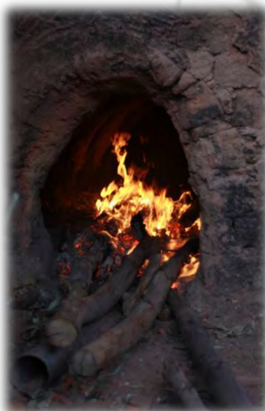
Foto 33: Encendido de horno romano, obsérvese el tubo para insuflar aire y mejorar el proceso de combustión.
