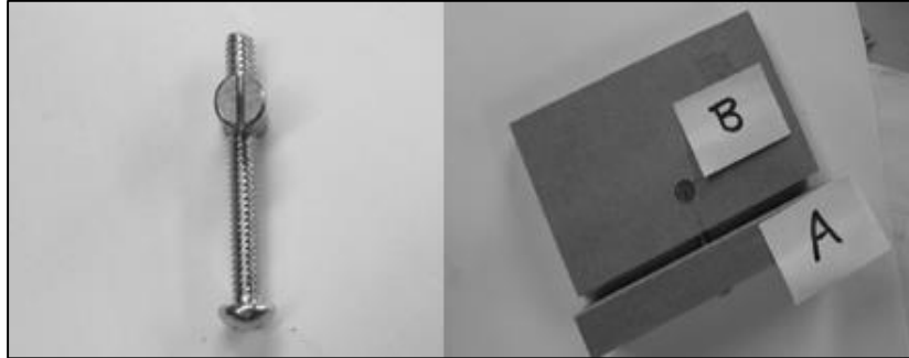
Figura N° 43. Unión de dos Tableros con Cross Dowel. Fuente: Patrick Hood- Daniel, James Floyd Kelly. (2009). Build Your Own CNC Machine. USA: Damon Larson.
