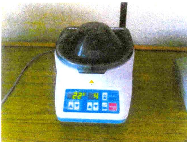
Centrífuga (2200 RPM X 4 minutos)
