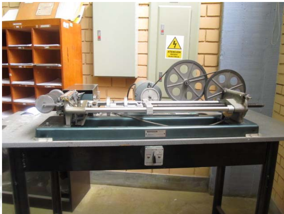
Maquina de Ensayos Universal Tipo Tensómetro Hounsfield Inglesa
