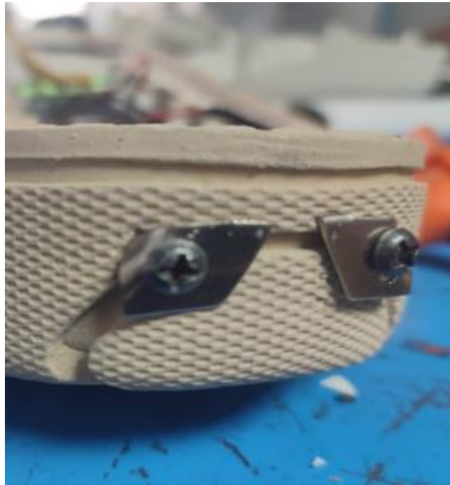
Figura 53 Ubicación de los electrodos
