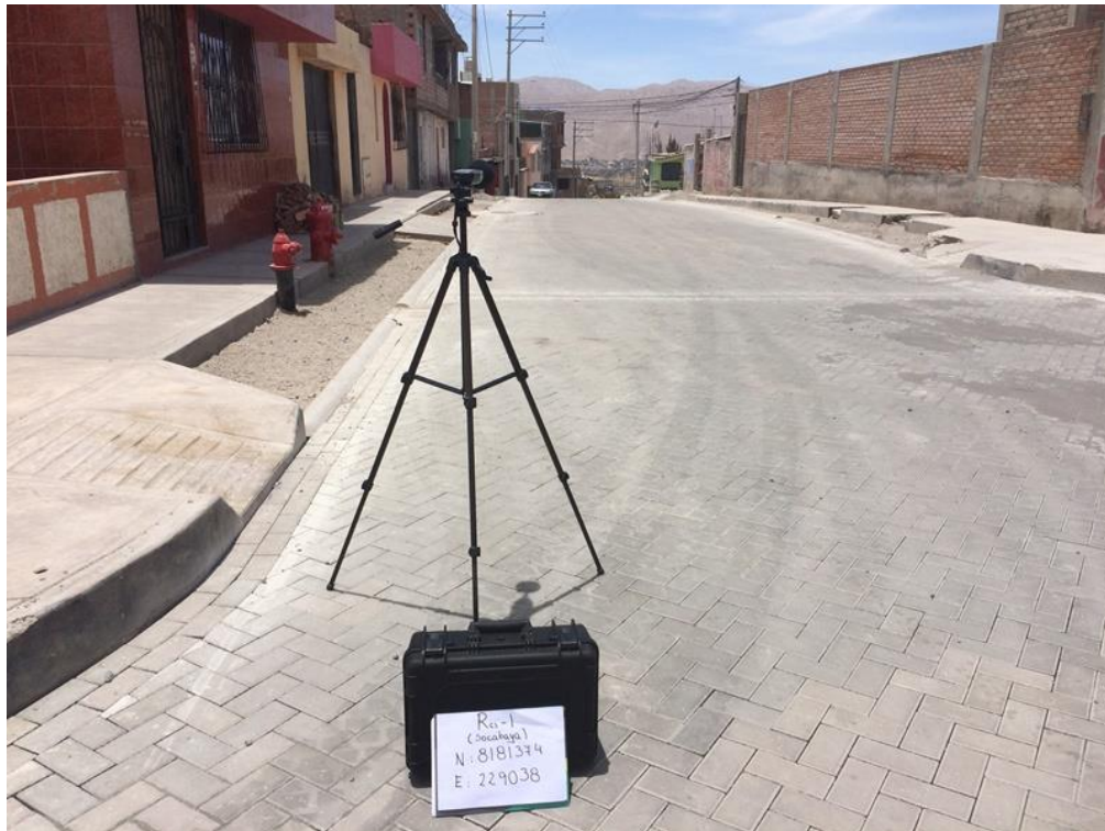
Figura 29. Estación de monitoreo de ruido ambiental R-1 durante la etapa de construcción del proyecto.
