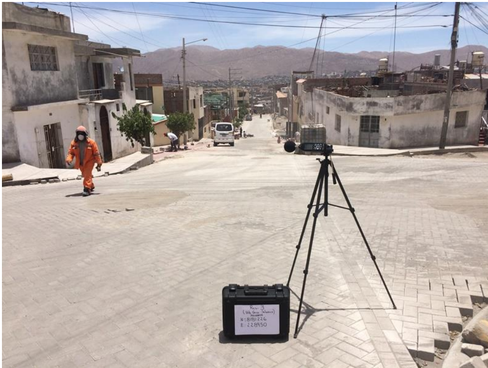
Figura 31. Estación de monitoreo de ruido ambiental R-3 durante la etapa de construcción del proyecto.
