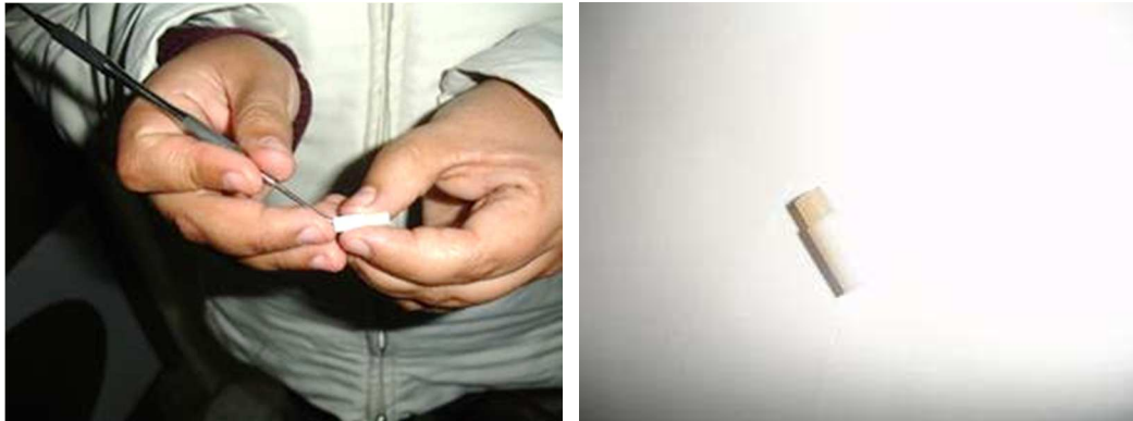
Foto N° 9 y 10: Retirando los cilindros listos de resina de las probetas.
