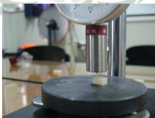
Foto N° 21: Prueba de la Dureza.
