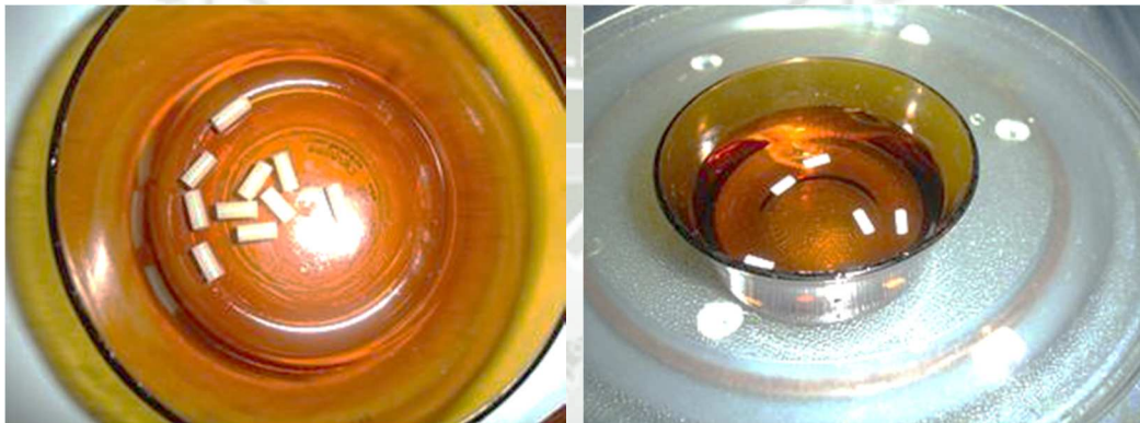
Fotos N° 11 y 12: Probetas sumergidas en agua en vaso pirex listas para llevar al microondas.
