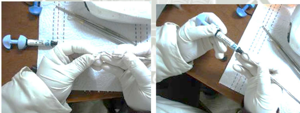
Fotos N° 5 y 6: Colocando la resina en las probetas y molde (por capas)
