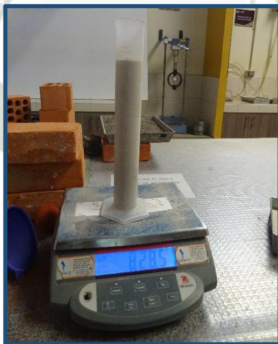
Figura N° 42: Registro del peso de 500 ml de arena graduada
