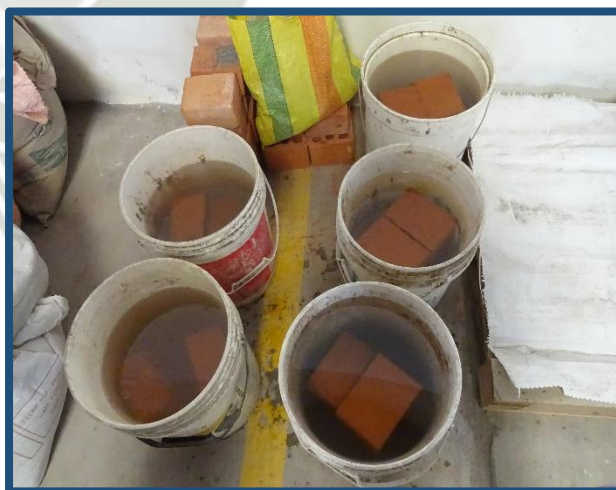
Figura N° 35: Saturación de las unidades artesanales e industriales, por un periodo de 24 horas
