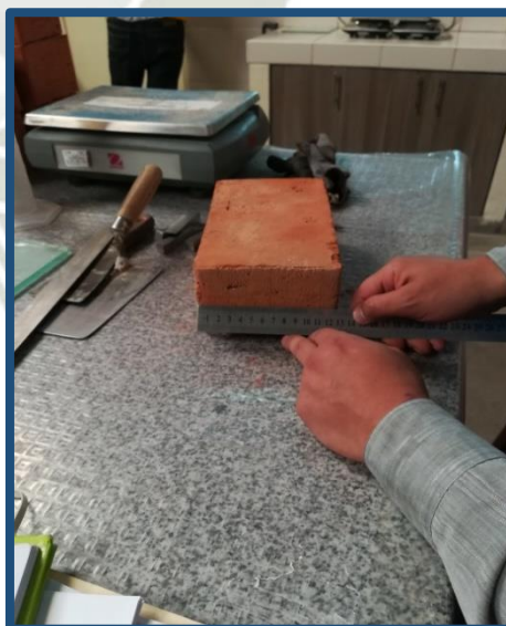
Figura N° 21 Medida del ancho del ladrillo artesanal
