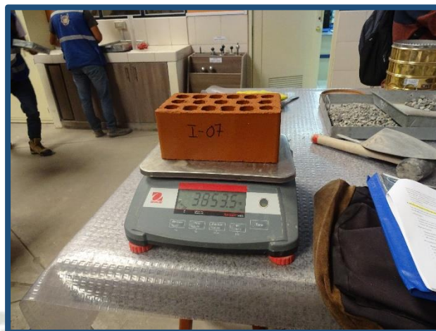
Figura N° 37: Registro de los pesos de las unidades saturadas superficialmente secas
