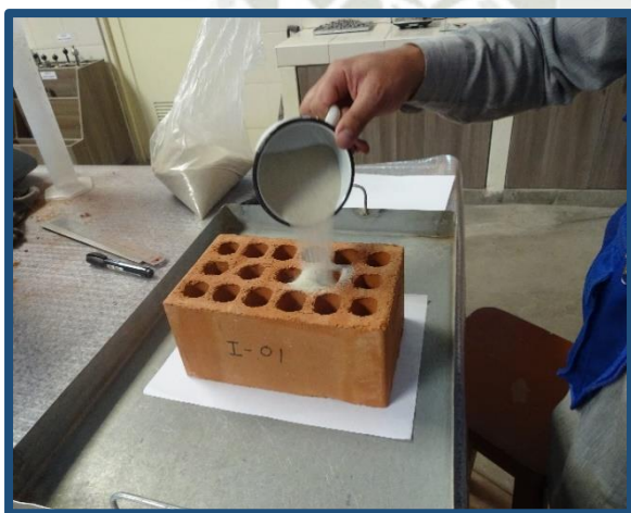
Figura N° 38: Rellenado de las perforaciones con la arena estándar
