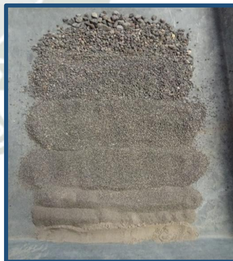
Figura N° 50: Registro del peso del material retenido en las mallas
