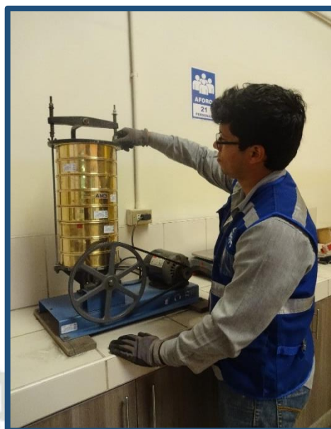
Figura N° 47: Ensayo de tamizado mecánico de la arena gruesa
