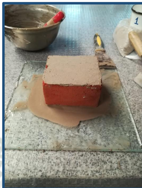
Figura N° 26: Elaboración del capping para la mitad de ladrillo artesanal
