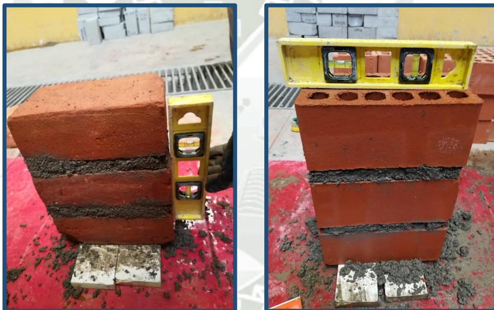
Figura N° 43: Elaboración de pilas o prismas de albañilería de ladrillo artesanal y de ladrillo industrial, verificando la verticalidad y horizontalidad de estas
