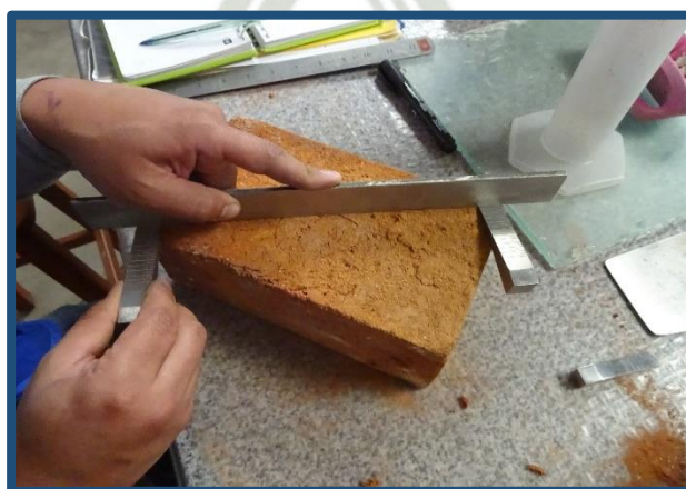
Figura N° 25: Medida de la convexidad del ladrillo artesanal
