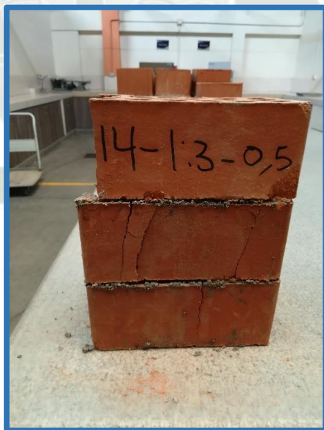
Figura N° 59: Falla por aplastamiento en prisma de unidades industriales
