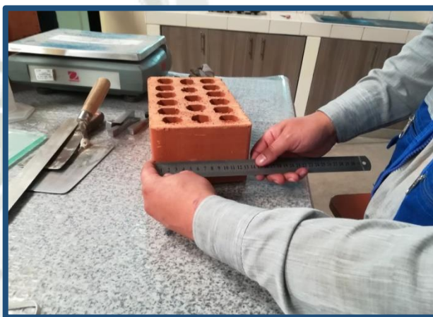
Figura N° 20: Medida del largo y ancho del ladrillo industrial
