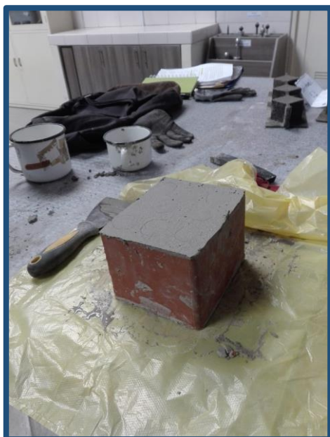
Figura N° 27: Elaboración del capping para la mitad de ladrillo industrial
