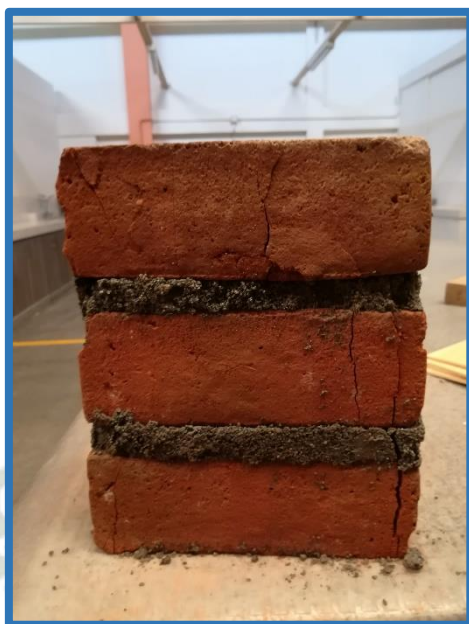
Figura N° 58: Falla por tracción lateral en prisma de unidades artesanales
