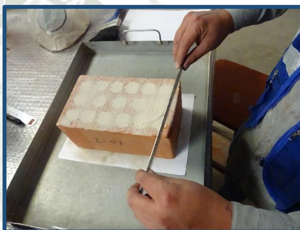
Figura N° 39: Enraizado de superficie con varilla recta
