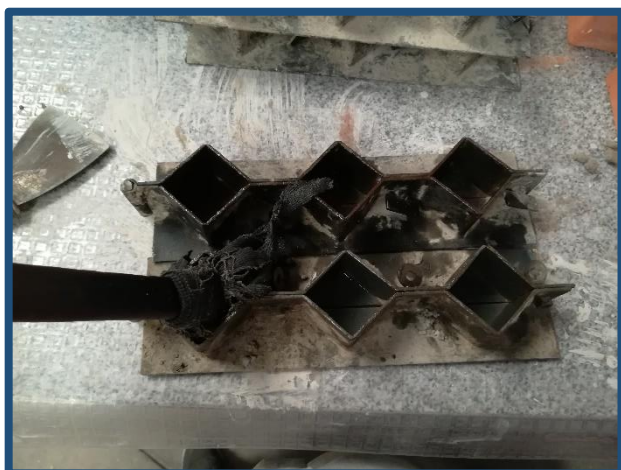
Figura N° 51: Engrasado de moldes para cubos de mortero
