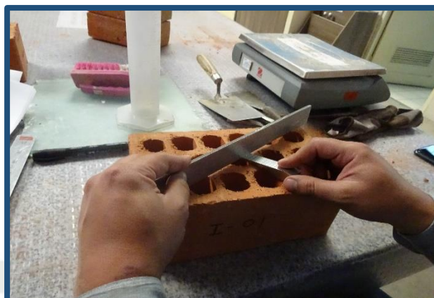
Figura N° 23: Medida de la concavidad del ladrillo industrial
