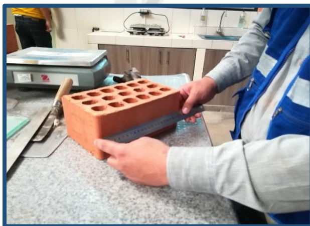
Figura N° 20: Medida del largo y ancho del ladrillo industrial
