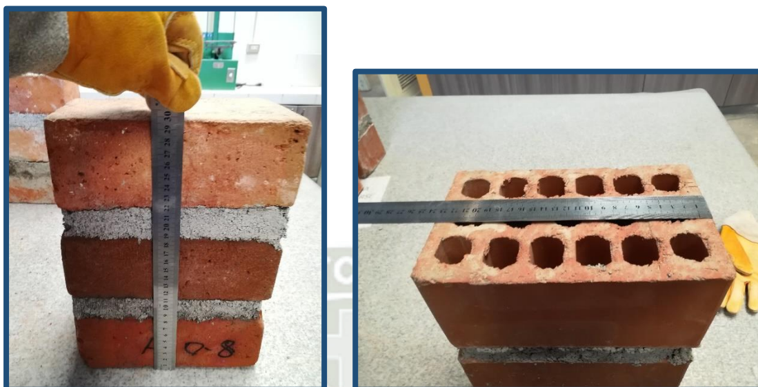
Figura N° 45: Registro de las dimensiones de los especímenes a ensayar
