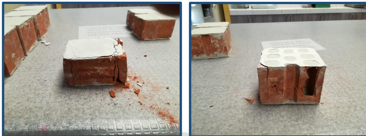
Figura N° 30: Fallas típicas después del ensayo de compresión en especímenes.
