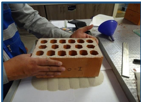
Figura N° 40: Se levanta el ladrillo para que la arena caiga en la hoja de papel
