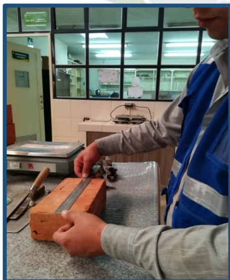
Figura N° 22: Medida del largo del ladrillo artesanal
