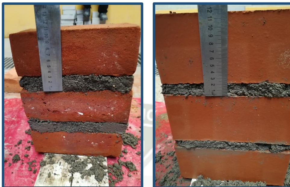
Figura N° 44: Control del espesor de junta de mortero deseado en los prismas de albañilería
