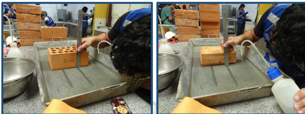
Figura N° 32: Control del nivel de agua para el ensayo de Succión
