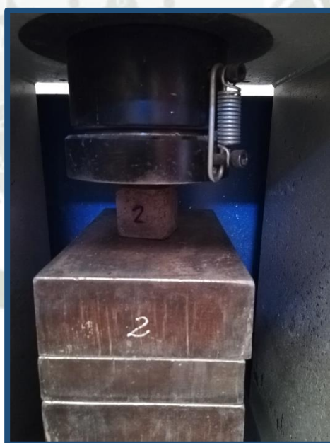
Figura N° 55: Ensayo a compresión del cubo de mortero
