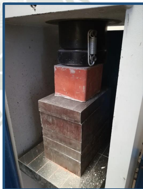
Figura N° 29: Ensayo de compresión de la mitad de ladrillo para la unidad industrial
