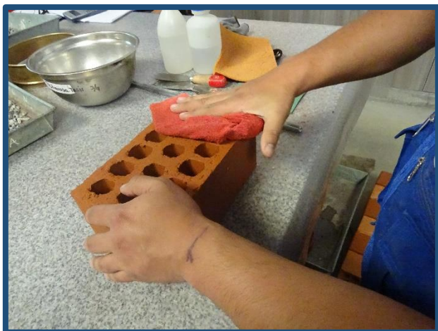
Figura N° 36: Secado superficial de las unidades
