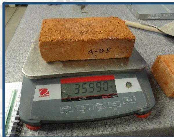
Figura N° 31: Registro de los pesos de los especímenes después de enfriar a temperatura ambiente
