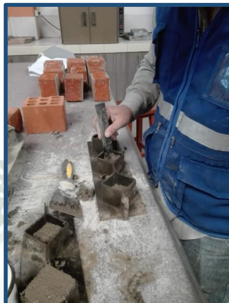
Figura N° 52: Apisonado del mortero en los moldes
