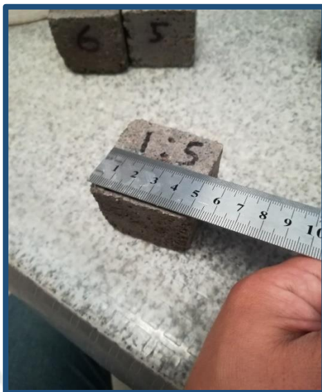
Figura N° 54: Registro de las dimensiones de los cubos de mortero
