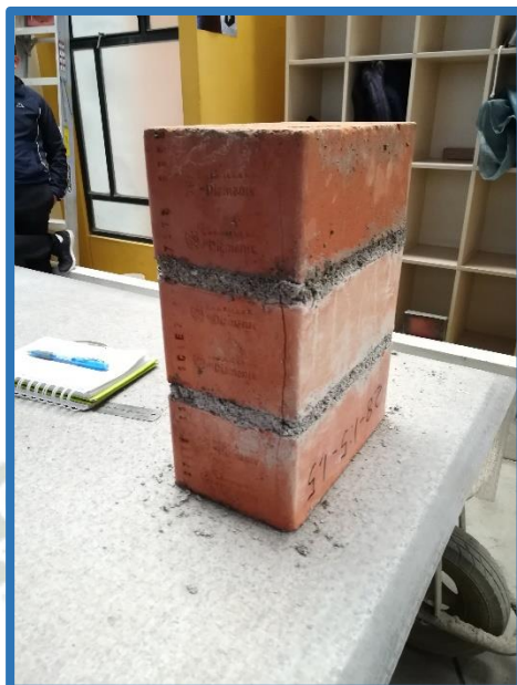
Figura N° 60: Falla por tracción lateral en prisma de unidades industriales
