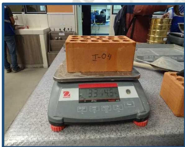
Figura N° 31: Registro de los pesos de los especímenes después de enfriar a temperatura ambiente
