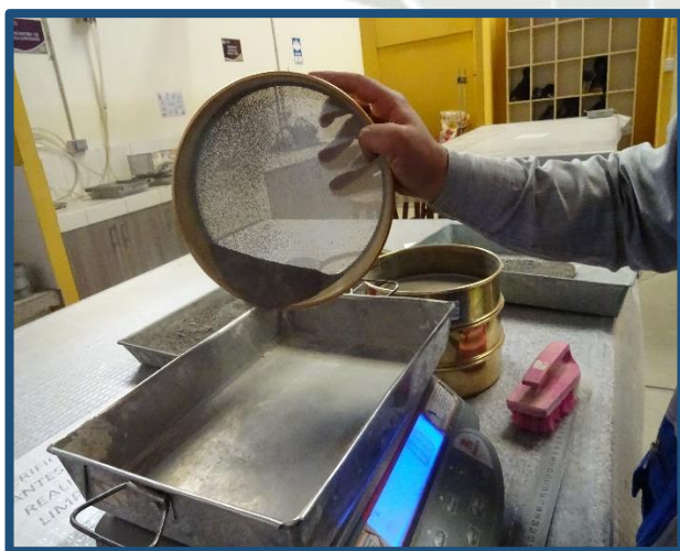
Figura N° 49: Registro de los pesos retenidos
