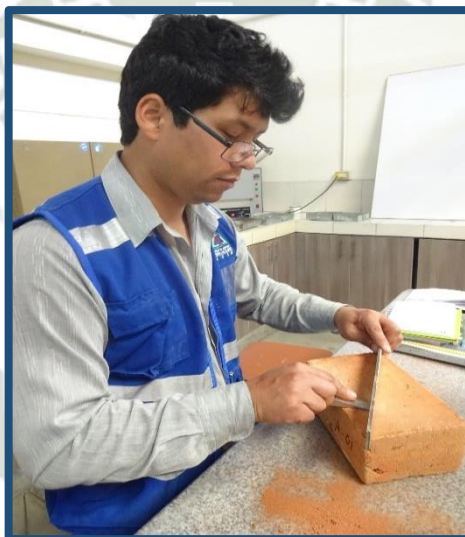
Figura N° 24: Medida de la concavidad del ladrillo artesanal
