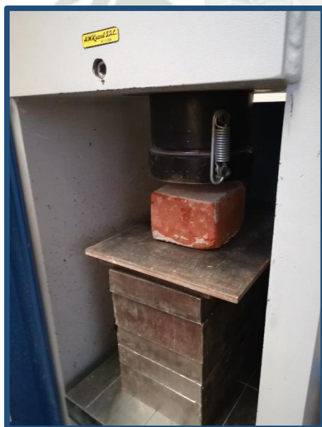
Figura N° 28: Ensayo de compresión de la mitad de ladrillo para la unidad artesanal
