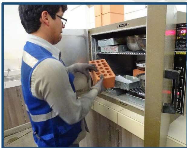
Figura N° 34: Secado al horno a temperaturas de 110^{\circ}\text{C} de los ladrillos
