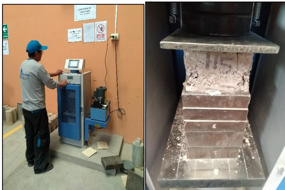
Figura. 7. Ensayo de compresión de unidades de albañilería de PET
