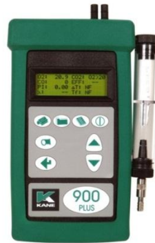
Fig N°14. Analizador de CO_2 : LANA SARRATE, modelo Khane 900 Plus. (García Vicente, 2010)
