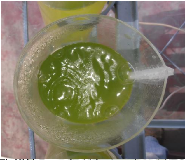
Fig N°24. Fotografía del funcionamiento del FBR.
