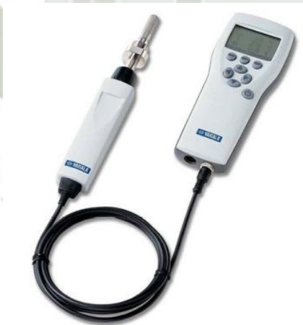
Fig N°13. Analizador de CO 2 : VAISALA, modelo MI70, utilizado para medir las concentraciones de CO 2 . (García Vicente, 2010)
