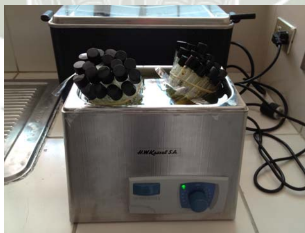
Figura N°15. Vista del Equipo de extracción asistida por ultrasonido, con muestras de rocoto.
