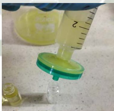
Figura N°40. Vista del filtrado de muestras con filtro de jeringa y disposición de muestra en viales.
