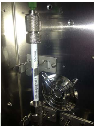
Figura N°43. Columna cromatográfica integrada al horno del equipo de HPLC , empleada para la determinación y cuantificación de Capsaicina.
