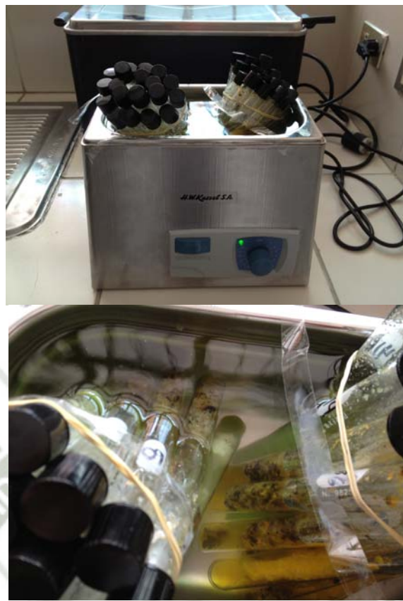
Figura N°37. Vista de extracción asistida por ultrasonido.
