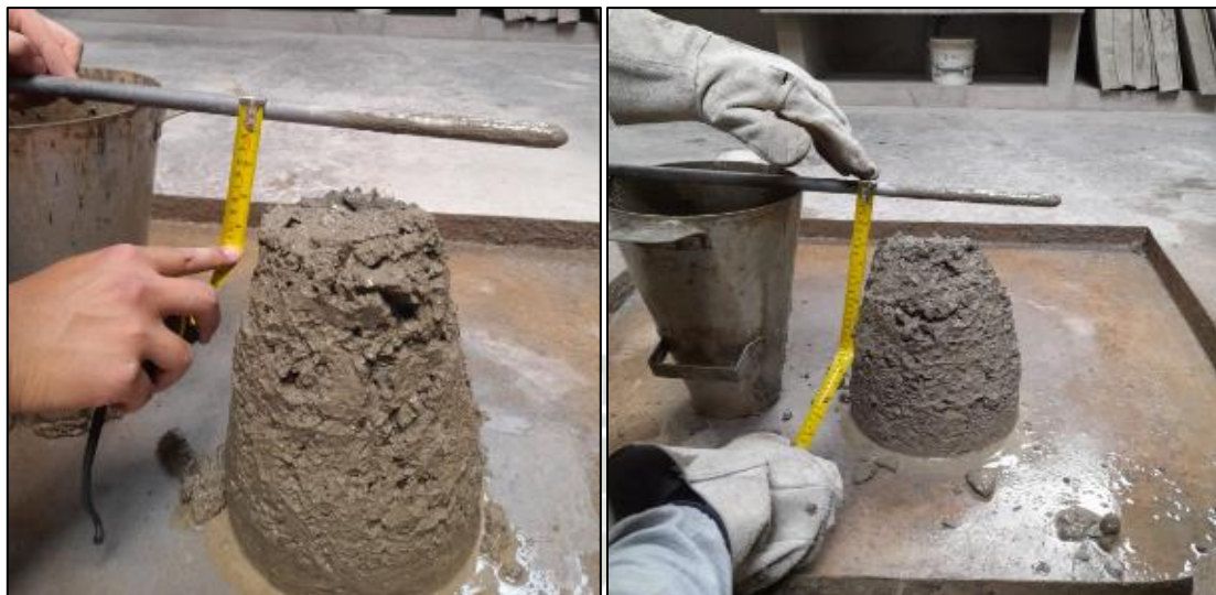
Ilustración 35 Determinación del grado de asentamiento del concreto fresco
