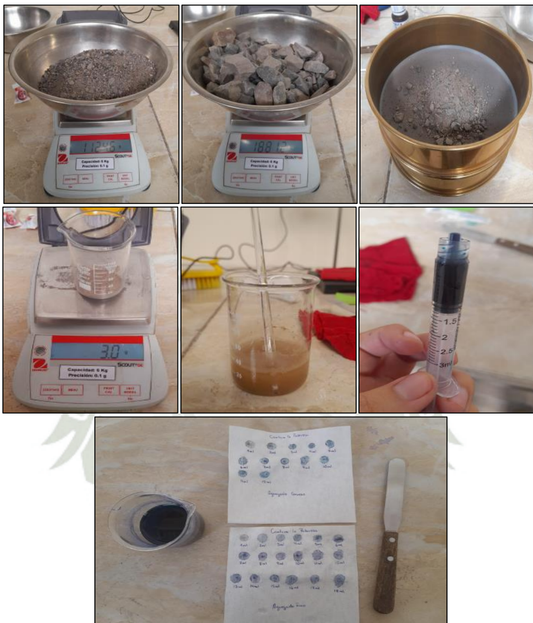
Ilustración 31 Determinación del azul de metileno de agregados
