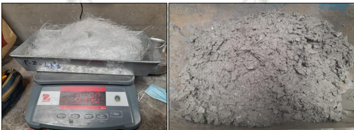
Ilustración 32 Mezcla de concreto adicionado con fibra de vidrio
