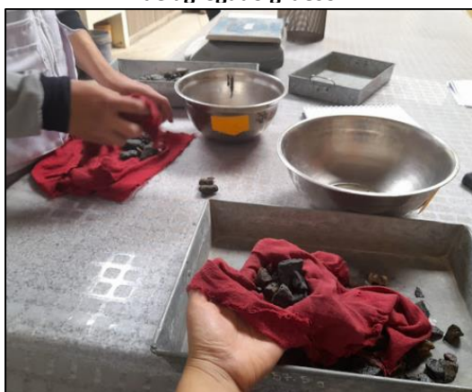
Ilustración 18 Secado superficial de la muestra de agregado grueso
