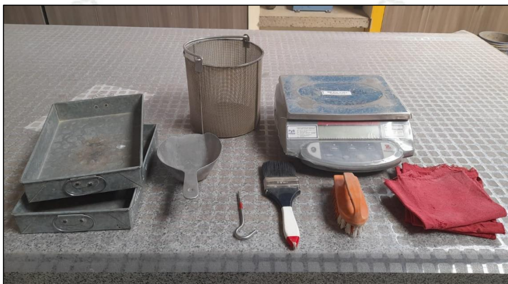
Ilustración 17 Equipo utilizado para realizar el ensayo de peso específico y absorción agregado grueso
