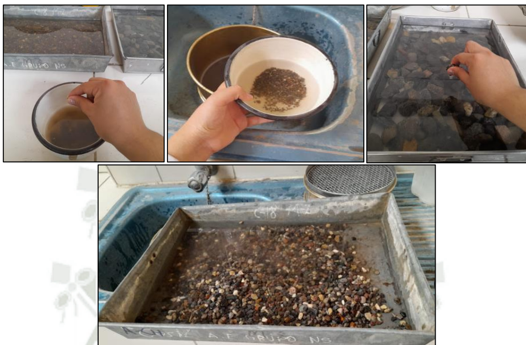
Ilustración 29 Determinación de terrones de arcilla y partículas desmenuzables de agregados
