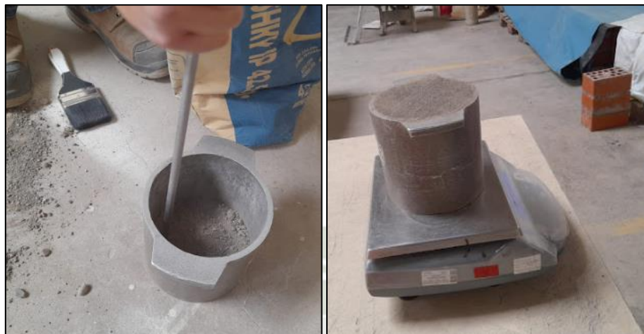
Ilustración 21 Determinación del peso unitario compactado del agregado fino
