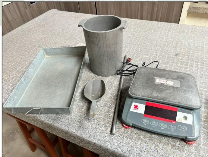
Ilustración 22 Equipo utilizado para realizar el ensayo de peso unitario del agregado grueso
