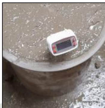
Ilustración 37 Determinación de la temperatura del concreto fresco
