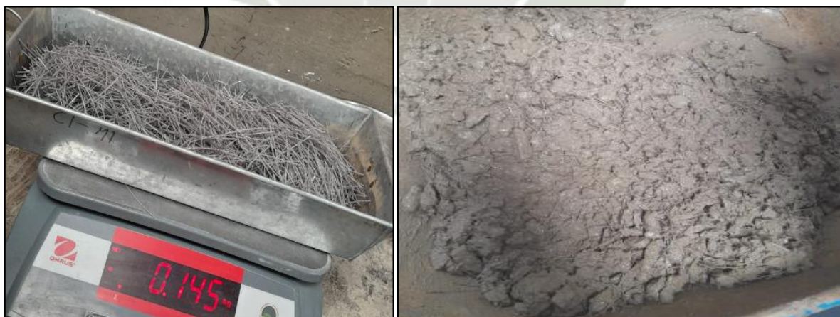
Ilustración 33 Mezcla de concreto adicionado con fibra de polipropileno
