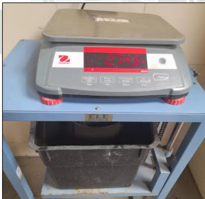
Ilustración 19 Ensayo de peso específico y absorción del agregado grueso
