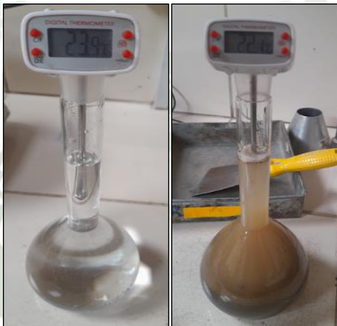
Ilustración 16 Método gravimétrico del ensayo de peso específico y absorción agregado fino
