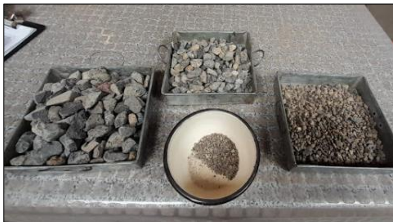
Ilustración 28 Preparación de muestras para determinar terrones de arcilla y partículas desmenuzables
