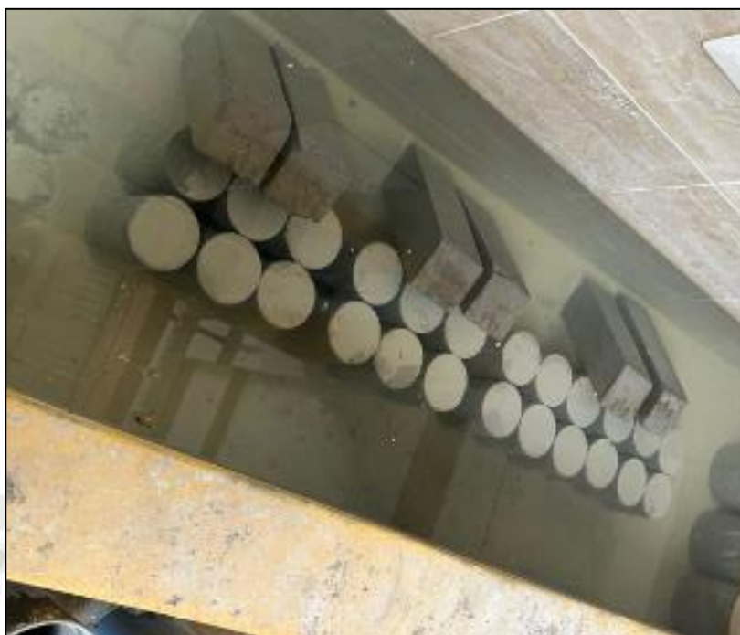
Ilustración 42 Poza de curado con especímenes cilíndricos y de vigas codificadas
