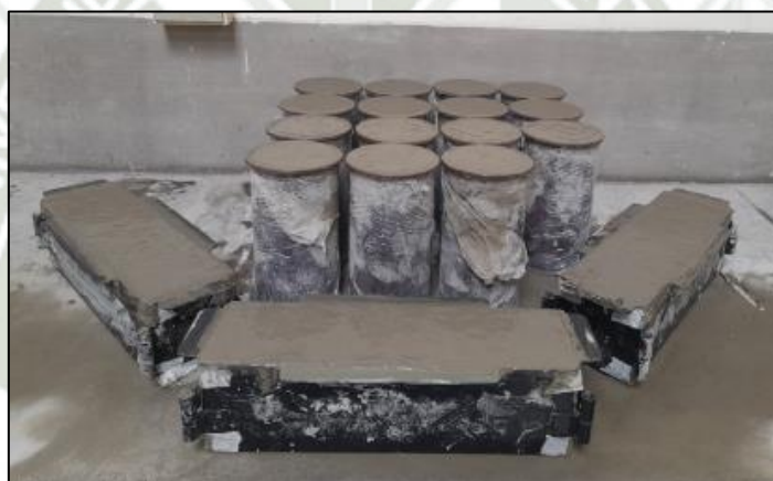
Ilustración 39 Especímenes moldeados debidamente
