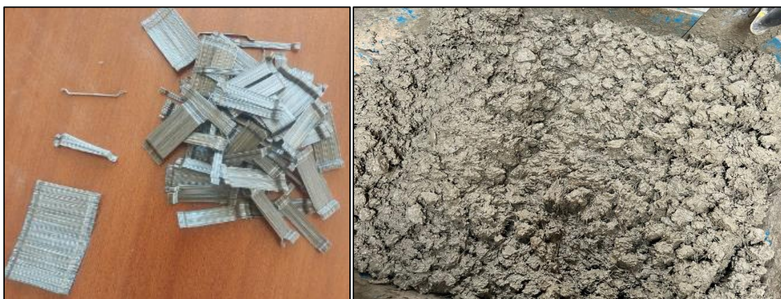
Ilustración 34 Mezcla de concreto adicionado con fibra de acero
