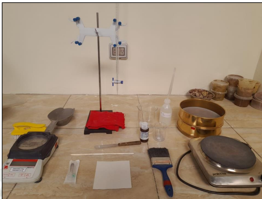
Ilustración 30 Equipo utilizado para determinar el valor de azul de metileno de los agregados
