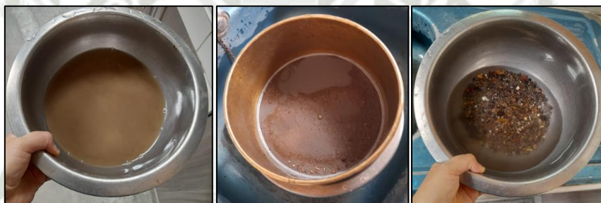
Ilustración 27 Determinación de material pasante de la malla N°200 del agregado fino
