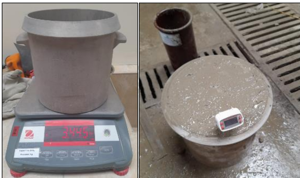
Ilustración 36 Determinación del peso unitario del concreto fresco
