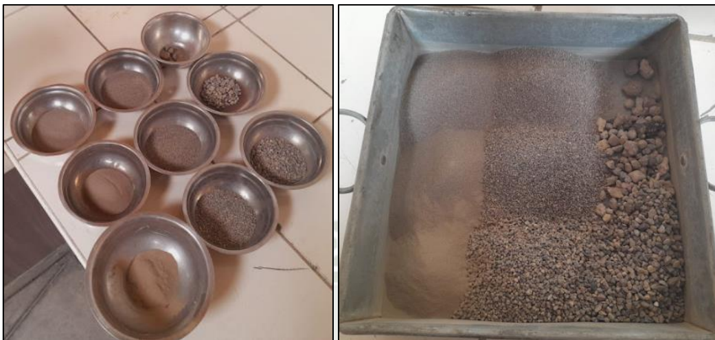
Ilustración 24 Determinación del análisis granulométrico del agregado fino
