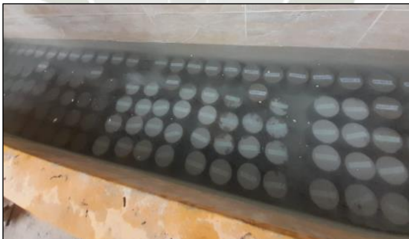
Ilustración 41 Poza de curado de especímenes cilíndricos codificados
