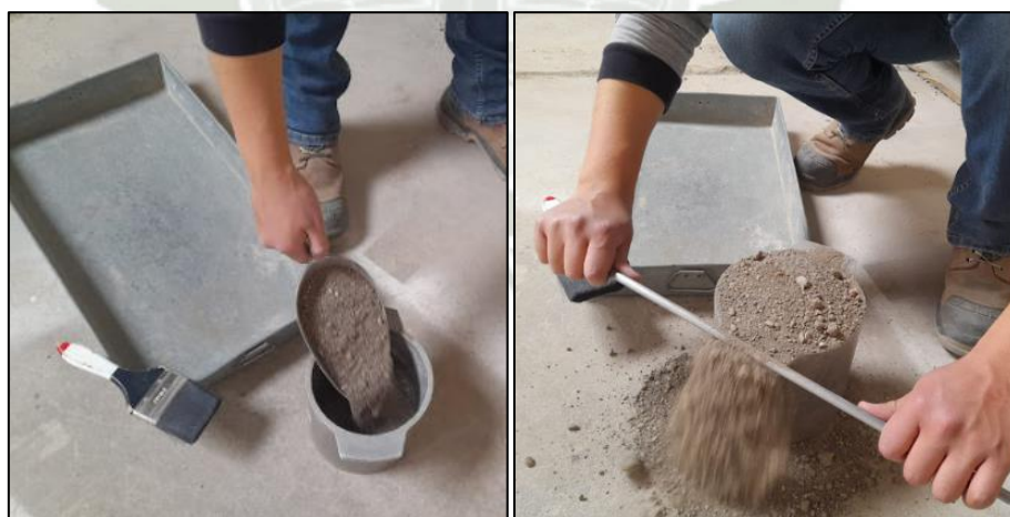
Ilustración 20 Determinación del peso unitario suelto del agregado fino
