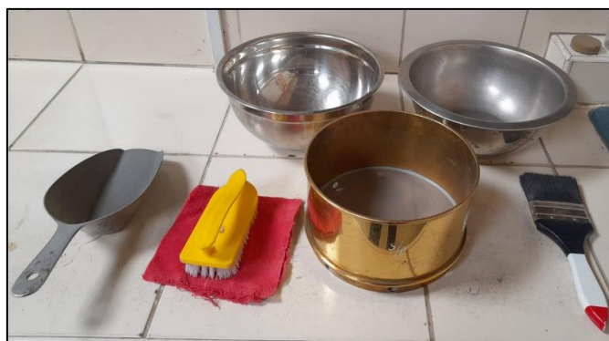
Ilustración 26 Equipo utilizado para determinar el pasante de la Malla N°200 del agregado fino
