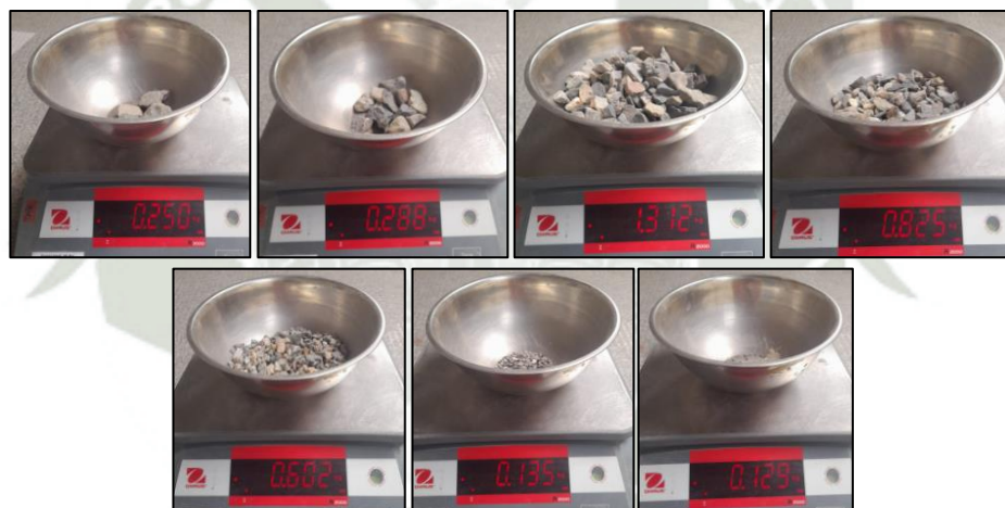
Ilustración 25 Determinación del análisis granulométrico del agregado grueso
