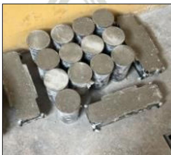
Ilustración 40 Secado de los especímenes de concreto por 24 horas
