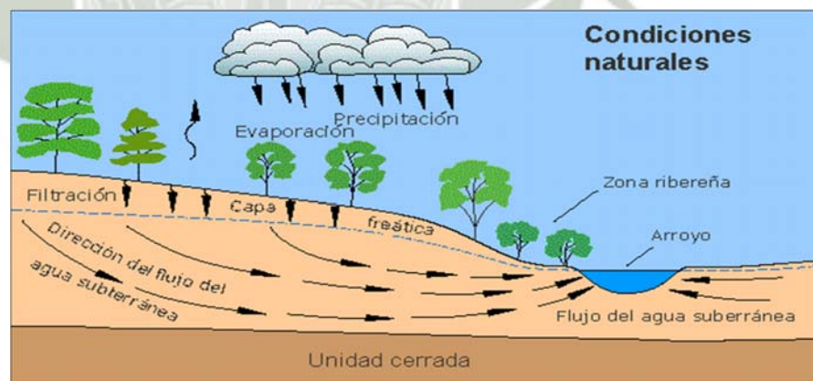
Flujo del agua subterránea.
