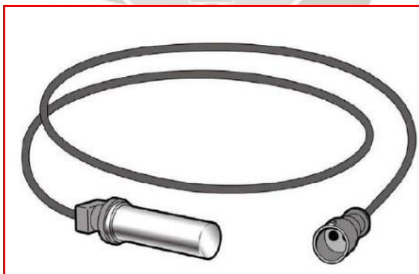
Figura Nº 62: Sensor de velocidad a la rueda.
