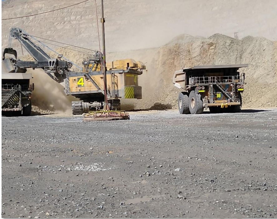
Figura 48 Condición del Piso de Pala 04. Fotografía del Piso de Pala 04 en condiciones no aptas para el cuidado de neumáticos, presentando rocas de gran tamaño. Fuente: Michelin, (2018).
