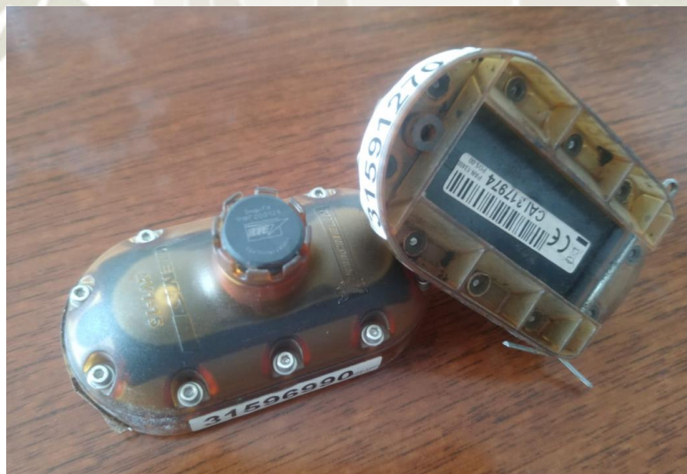
Figura 52 Sensores de Sistema MEMS. Sensores correspondientes al sistema MEMS que son insertados al interior de los neumáticos 59/80R63 para el seguimiento de presión y temperatura. Fuente: adaptación propia en base a la investigación realizada, 2019.
