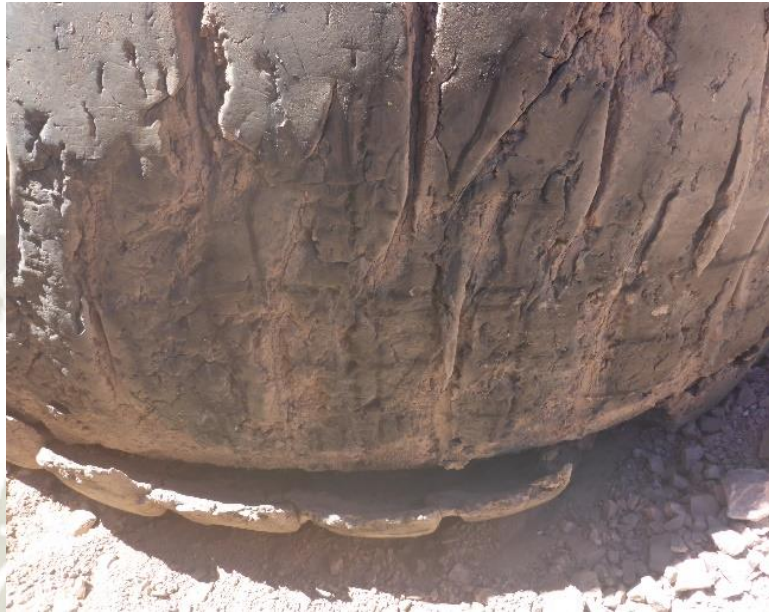
Figura 63 Fotografía de separación mecánica. Fotografía de neumático desechado por separación mecánica. Fuente: Bridgestone, (2019).
