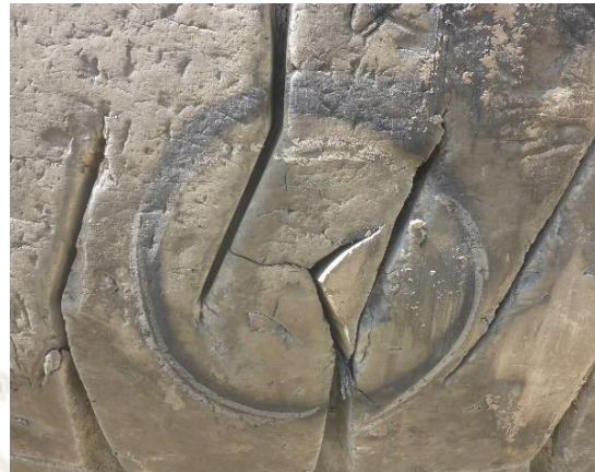
Figura 58 Fotografía de corte roca. Fotografía de neumático desechado por corte de roca. Fuente: adaptación propia en base a la investigación realizada, 2019.
