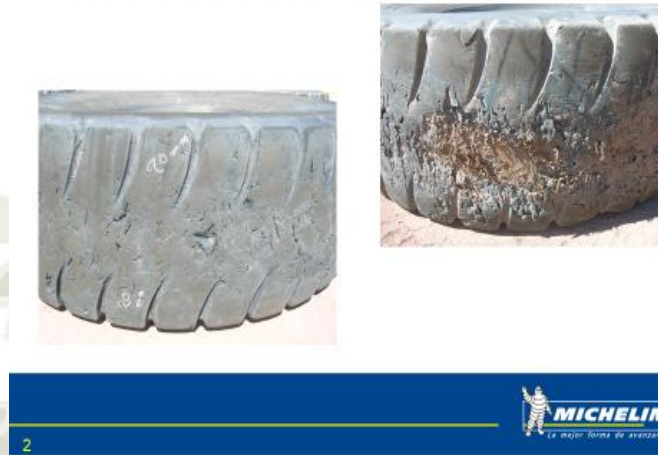
Figura 19 Diferencia entre neumáticos con y sin patinaje. Diferencia entre un neumático sin patinaje y con patinaje. Adaptado de "Formación de operadores - neumáticos" por Michelin, 2005, p. 26.
