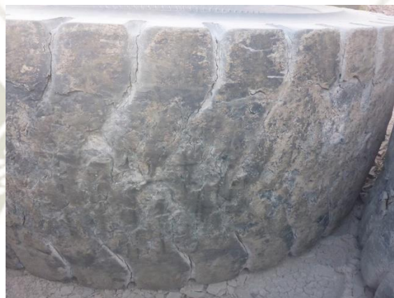
Figura 67 Neumático con desgaste final de tipo Chunking. Neumático con desgaste final de tipo Chunking con arrancamientos de trozos de la banda de rodamiento. Fuente: adaptación propia en base a la investigación realizada, 2019
