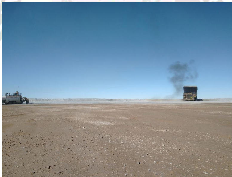
Figura 66 Fotografía Botadero QH lastrado. Botadero QH con el piso lastrado para un mejor cuidado de neumáticos. Fuente: adaptación propia en base a la investigación realizada, 2019
