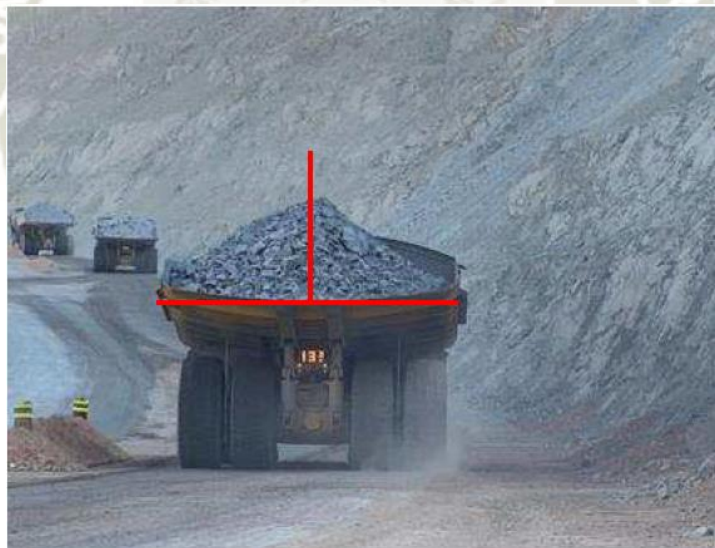
Figura 37 Carga descentrada. Fotografía de volquete con carga descentrada dentro de la unidad minera de estudio. Fuente: Michelin, (2018).
