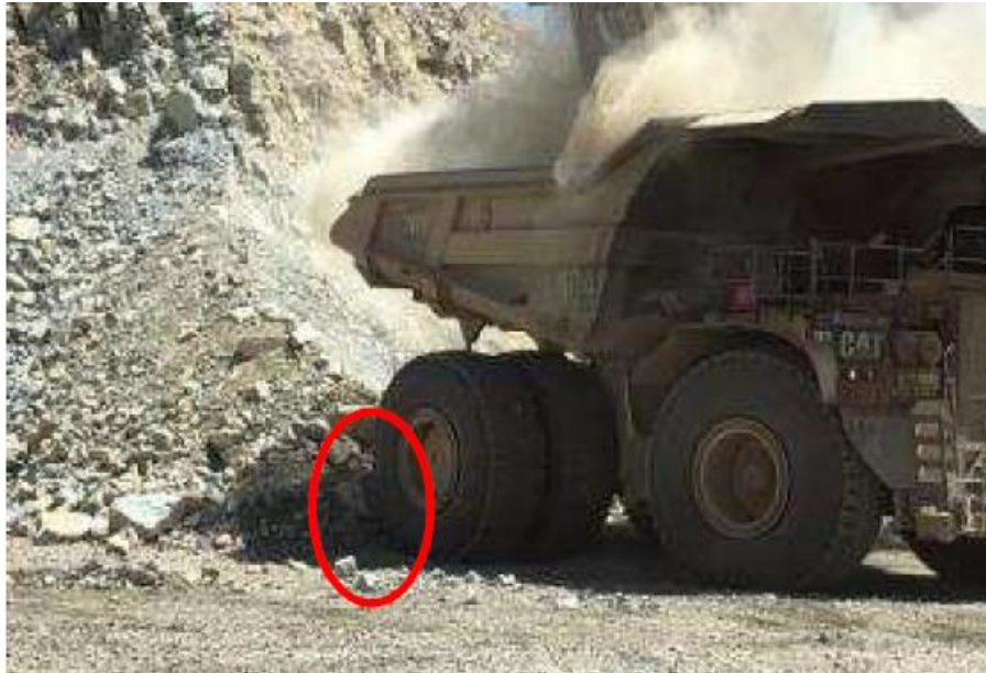
Figura 47 Neumáticos en contacto con rocas. Neumáticos en posición 5 y 6 en contacto con rocas en el frente de minado, las cuales pueden ocasionar daños al mismo. Fuente: Michelin, (2018).
