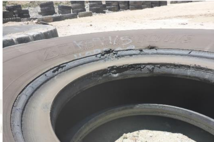
Figura 38 Daños en neumático por sobrecarga. Daños en talón y flanco del neumático producto de sobrecarga del volquete. Fuente: Michelin, (2018).
