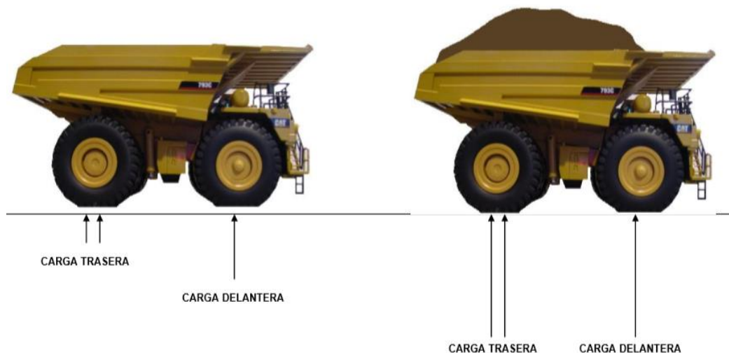
Figura 6 Distribución de la carga con el volquete vacío y cargado. Cuando el volquete se encuentra vacío, los neumáticos delanteros reciben el doble de carga que los neumáticos traseros; sin embargo, cuando está cargado, el peso recae en el eje posterior y genera una carga igual para todos los neumáticos, teóricamente Fuente: Pro-Activos,( 2012).
