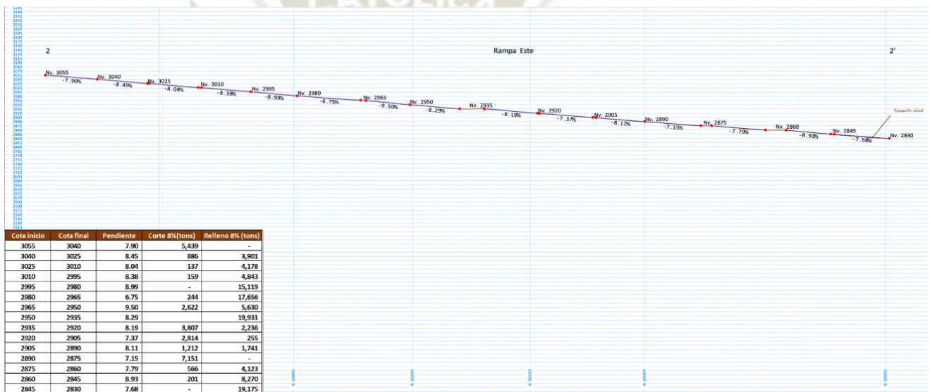
Figura 44 Pendiente de la Rampa Este entre cotas 2845 - 3055. Se puede observar la pendiente que tiene la Rampa Este cada 15 metros de cota. Fuente: adaptación propia en base a la investigación realizada, 2019.
