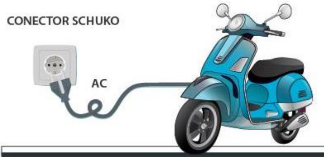
Figura 28. Modo 1 AC de carga
