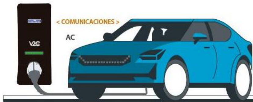
Figura 30. Modo 3 AC de carga SAVE O 'WALLBOX'
