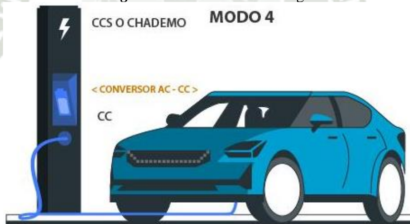
Figura 31. Modo 4 CC de carga
