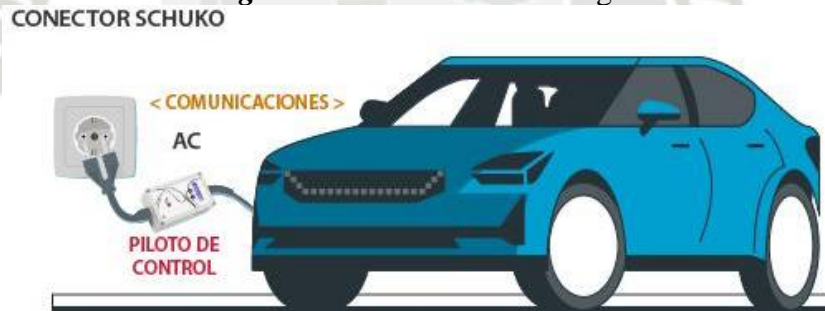
Figura 29. Modo 2 AC de carga
