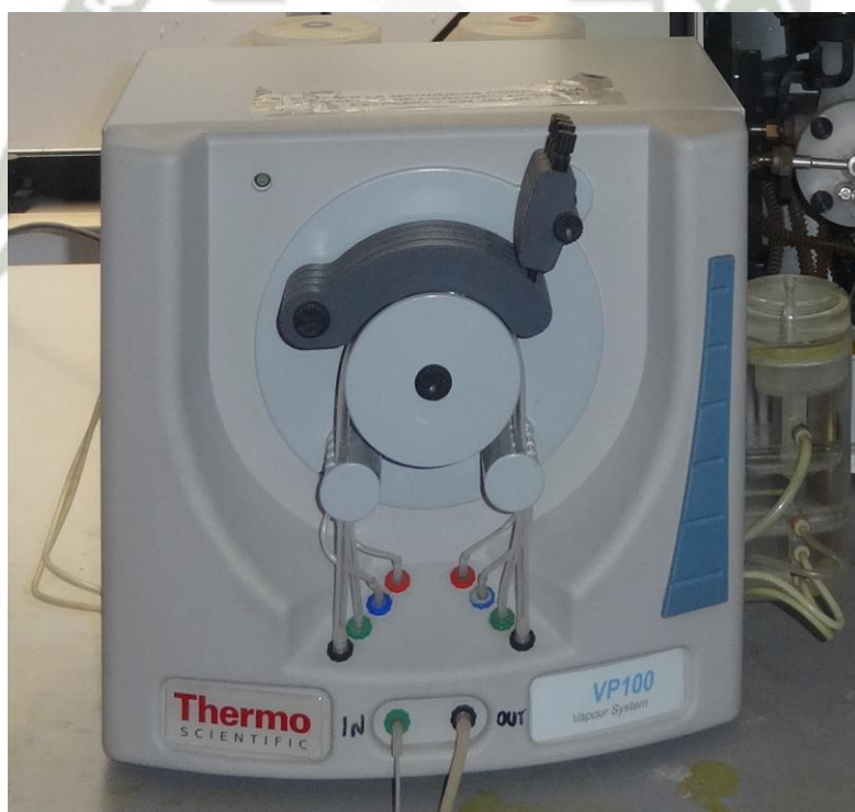
FIGURA N° 13: GENERADOR DE HIDRUROS
