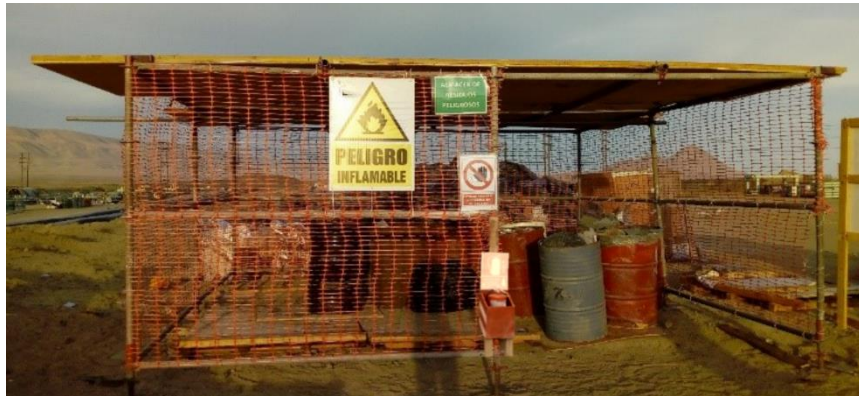
Figura 12: Almacén temporal de RR.SS. Peligrosos.
