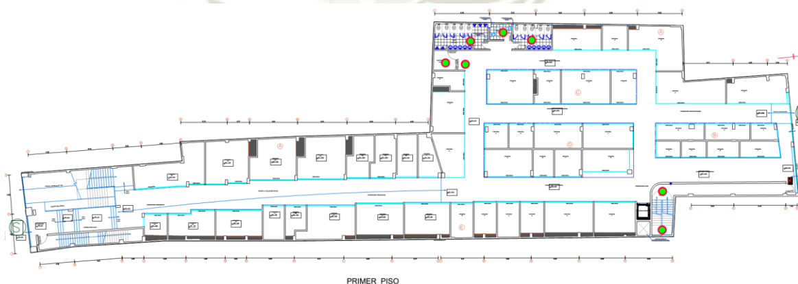
Figura 34: Ubicación de sensores de presencia en primer piso
