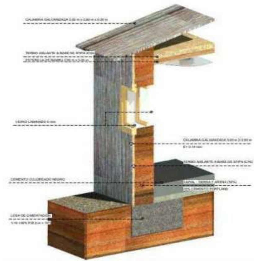
Ilustración 106: Detalle constructivo muro tapial revestido térmicamente
