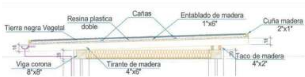
Ilustración 21: Detalle de Cubierta
