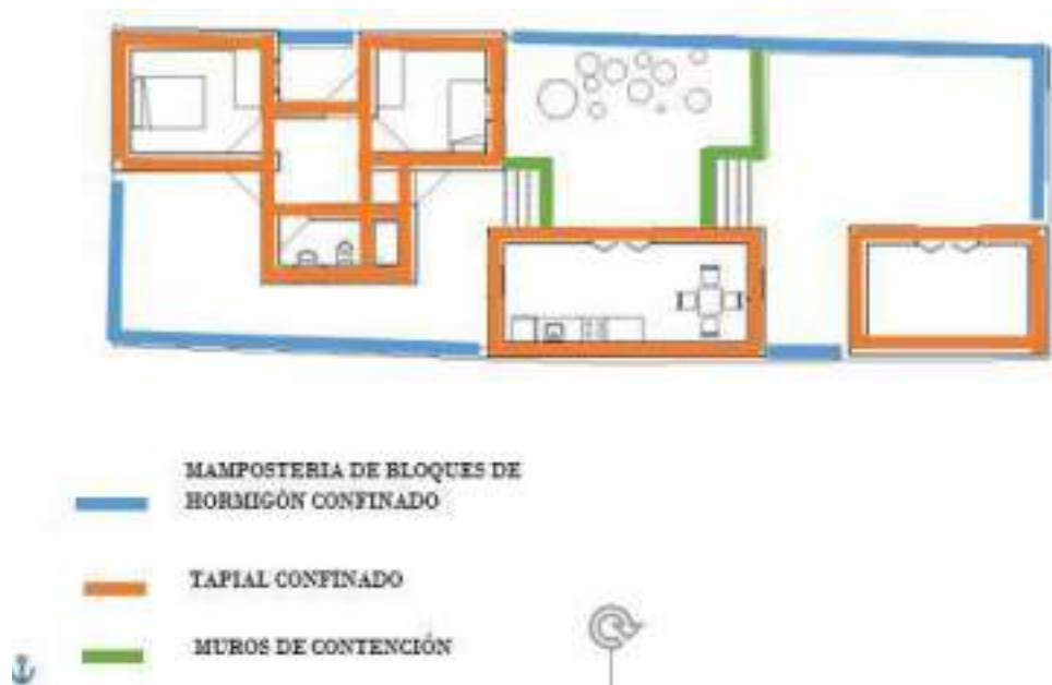
Ilustración 96: Esquema de estructuración vivienda establo
