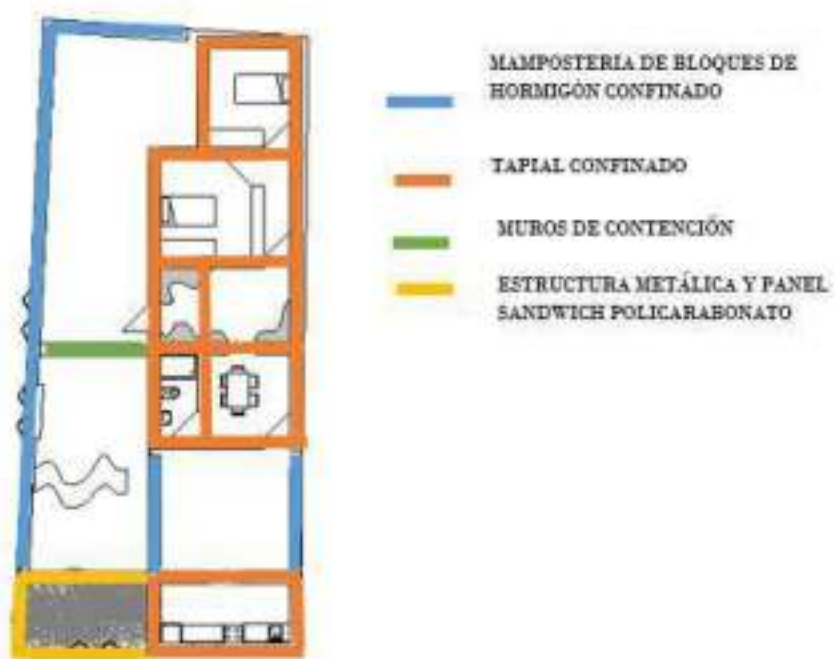
Ilustración 97: Esquema de estructuración vivienda Fitotoldo
