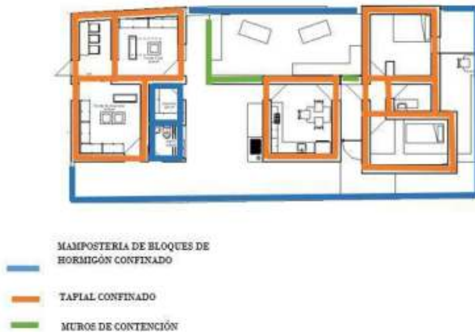
Ilustración 98: Esquema de estructuración Vivienda Textil
