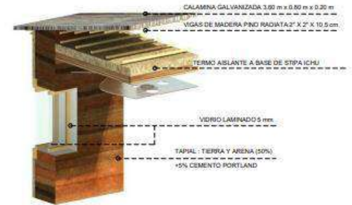
Ilustración 109: Detalle constructivo falso techo
