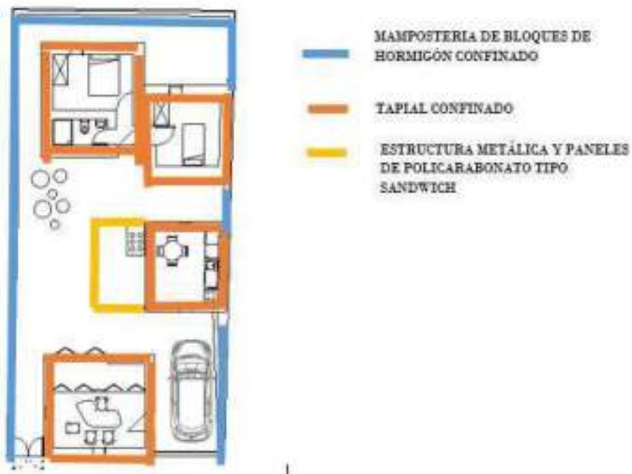
Ilustración 95: Esquema de estructuración por sistema constructivo vivienda salinera
