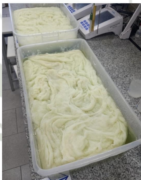
Figura 26. Extracto de nopal sumergido en etanol al 95%.
