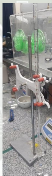
Figura 28. Titulación de HCl 1M con NaOH 1M.
