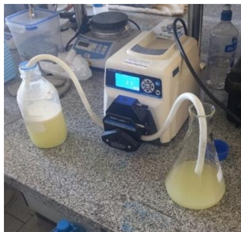
Figura 45. Proceso de desgrasado empleando la bomba a vacío.
