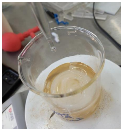
Figura 35. Regeneración de quitosano con NaOH 1M.
