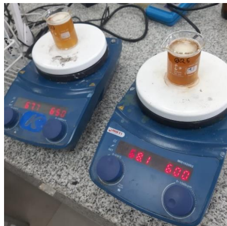
Figura 43. Proceso de elaboración de las biopelículas conformadas por quitosano y mucílago de nopal ( Opuntia ficus indica ).
