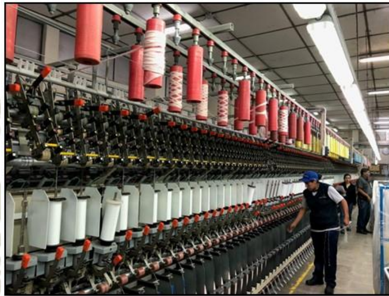
Figura 25. Descarga de bobinas de mecha Fuente: Michell y Cía S.A.
