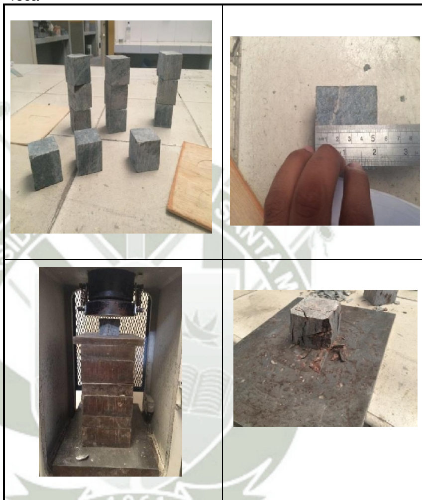
FIGURA N° 3.18. Ensayo a compresión de Piezas cubicas de roca
