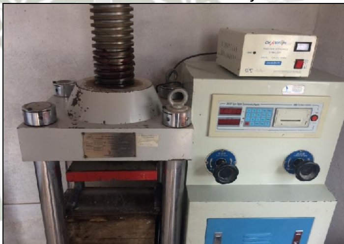
FIGURA N° 4.02. Procedimiento de ensayo ASTM C78
