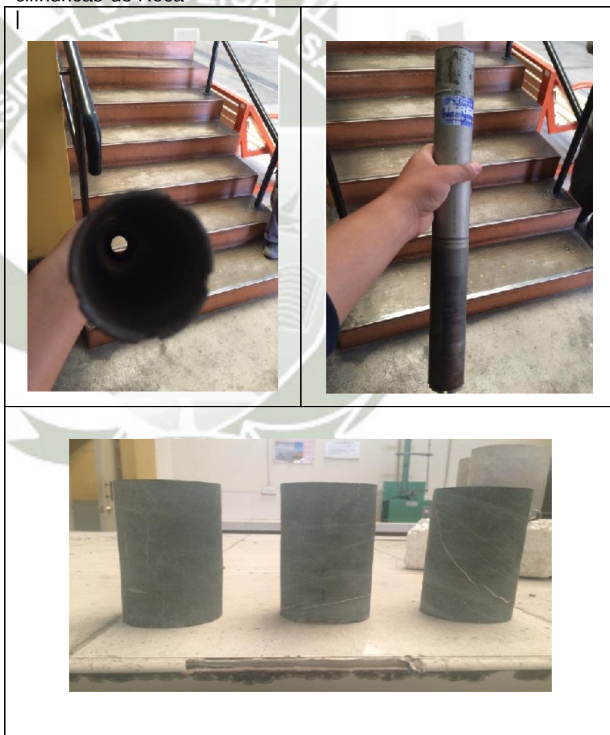
FIGURA N° 3.17. Ensayo a compresión de muestras cilíndricas de Roca
