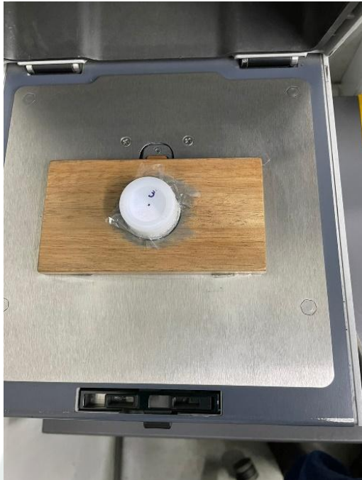
Figura 30. Colocación de briqueta en soporte
