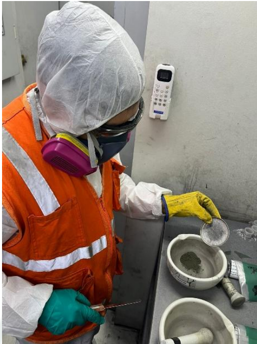
Figura 19. Vertido de concentrado en mortero
