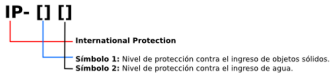
Figura N° 90. Nomenclatura de protección IP de motores eléctricos. (Fuente: Wikipedia)
