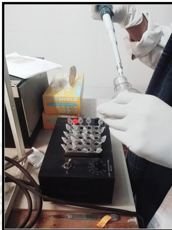
Foto 3. Deshidratación/volatilización de las muestras posteriores Al desparafinado con XILOL y lavado con etanol.
