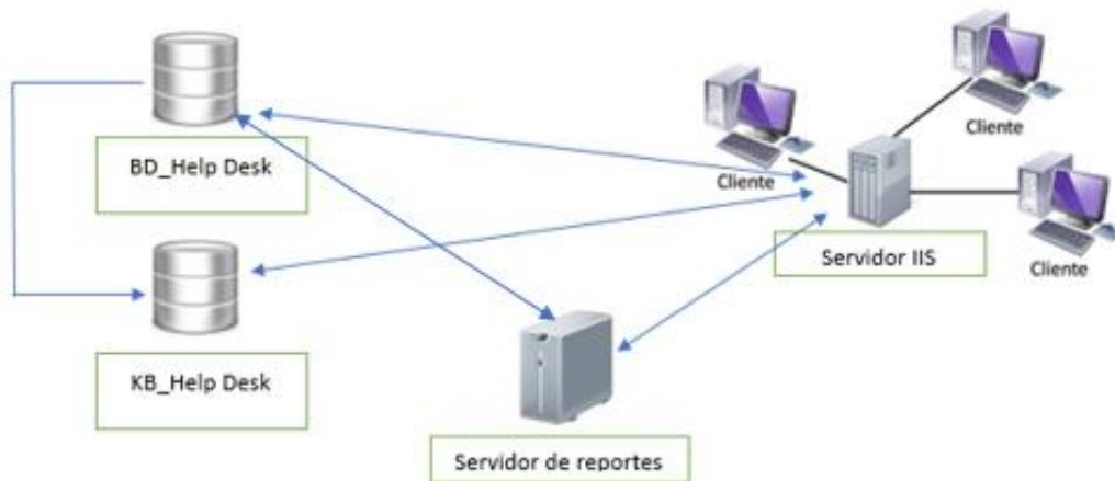
Figura 25: Arquitectura del sistema
