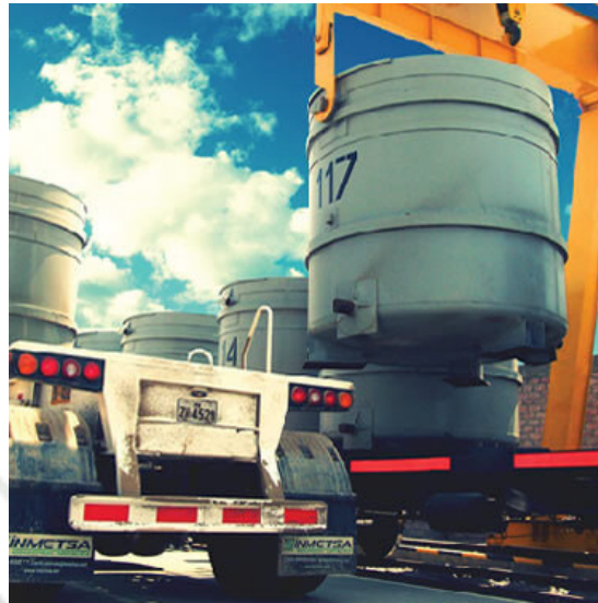
Figura N°23. Traslado de contenedores a la plataforma mediante puente grúa
