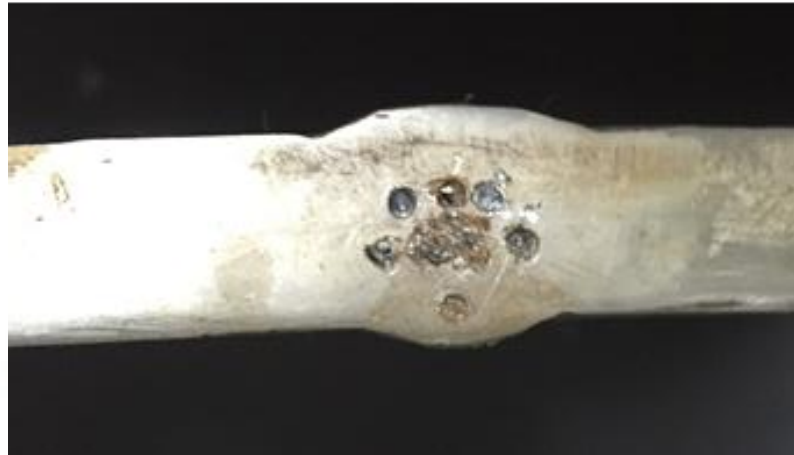
Figura 5-12: Cupón de Soldadura con Inserción de Reflectores de agrupados
