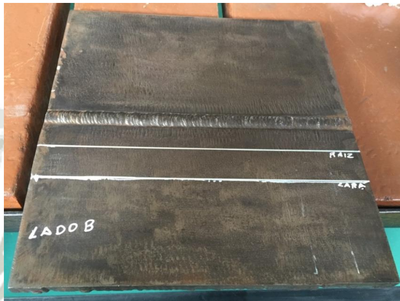
Figura 5-1: Cupón de Soldadura Soldado con WPS –UCSM-PPIMEM-001
