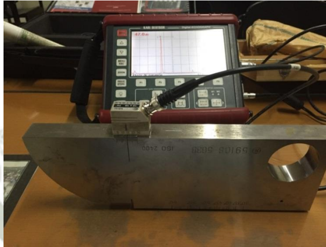
Figura 3-21: Posición del transductor para calibración de distancia
