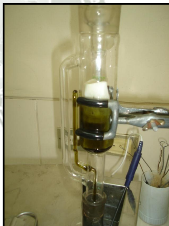
Figura N° 3.12 Extracción de aceite de microalgas en equipo Soxhlet – Sifoneado.
