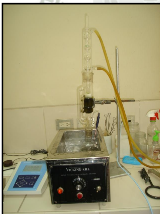
Figura N°3.11 Extracción de aceite de microalgas en equipo Soxhlet
