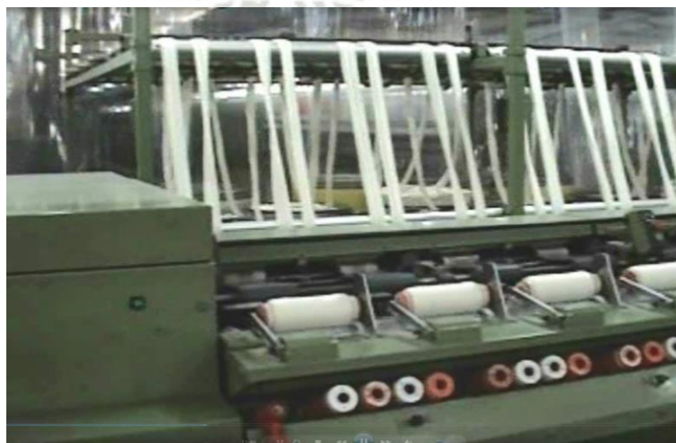
Figura N° 15: Proceso de preparación alta, frotadora
