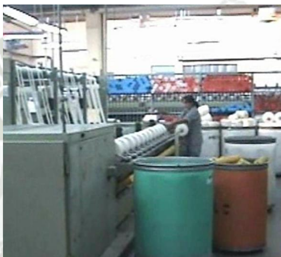
Figura N° 32: Retiro de muestra de mechilla
