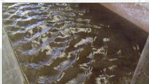
Figura 7. 13, Antidunas producidas en lo largo del ancho del modelo de río. PA
