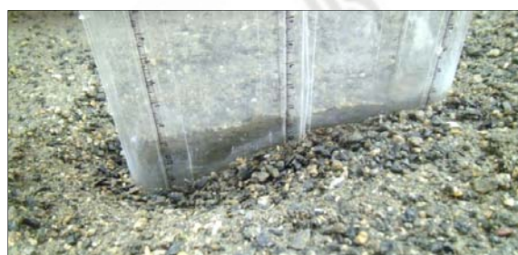
Figura 7. 14, Fondo de lecho acorazado después del ensayo con granulometría gruesa. PA
