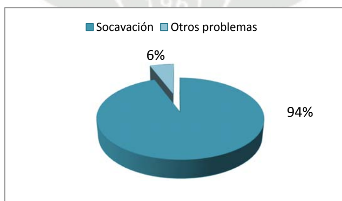
Figura 2.2 Causa del colapso de puentes ocurridos en avenidas. PA
