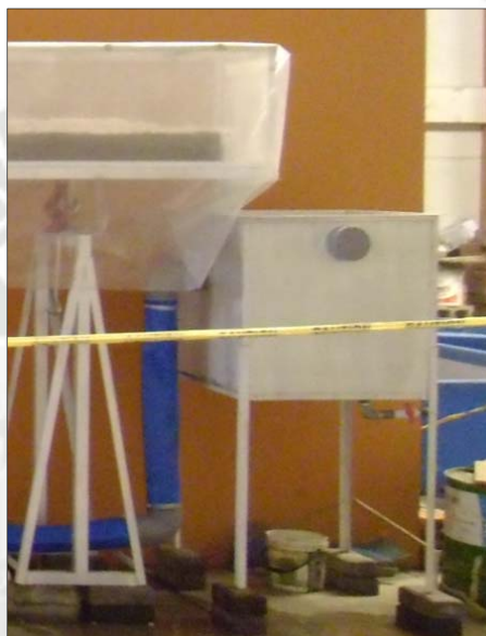
Figura 6. 8, Desarenador/Tanque de disipación ensamblado. PA
