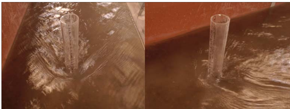
Figura 7. 15, Ondas de choque para un pilar aislado. PA
