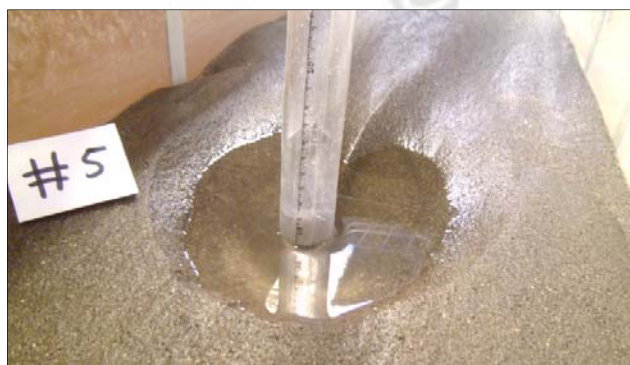
Figura 7. 8, Fosa de socavación para un pilar circular, d_{50} = 0.73 \text{ mm} PA
