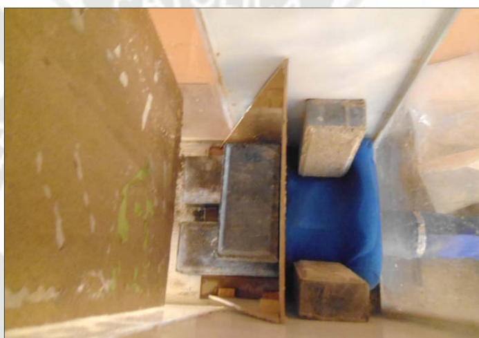
Figura 6. 10, Obstáculo colocador a la salida de agua al tanque de aproximación PA
