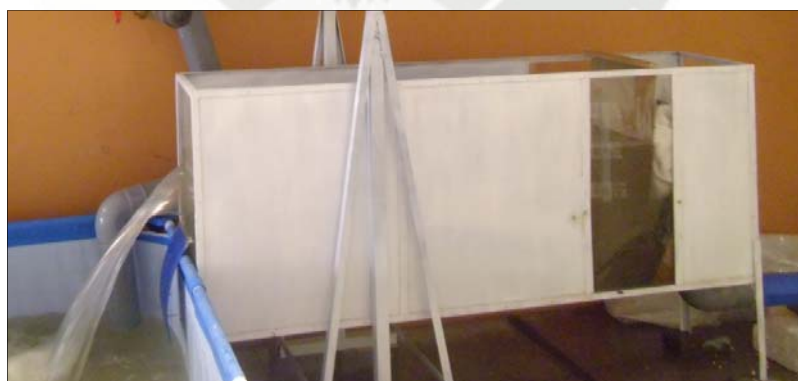
Figura 6. 11, Vertedero en funcionamiento. PA
