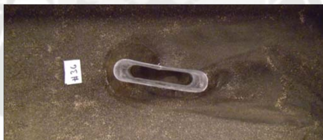
Figura 7. 10, Fosa de socavación para un pilar alargado, d_{50} = 0.73 \text{ mm} ángulo de incidencia 10^\circ \text{ PA}
