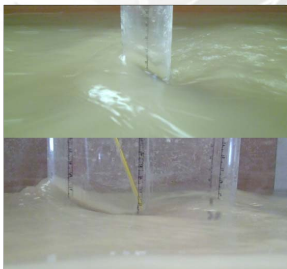
Figura 7. 17, Perfil del nivel de agua alrededor de un pilar circular y un pilar alargado. PA
