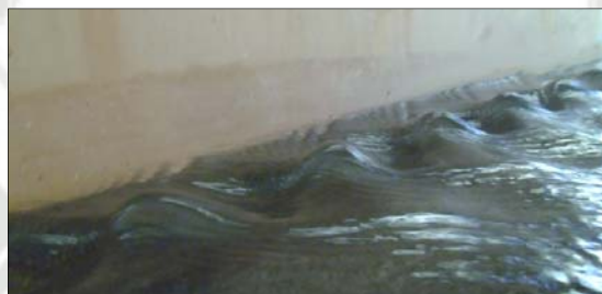
Figura 7. 12, Antidunas producidas en zona localizada PA
