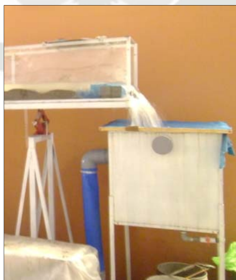
Figura 6. 9, Desarenador/Tanque de disipación en funcionamiento. PA
