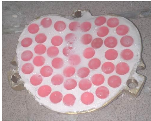
Colocación de los discos de cera en yeso piedra
