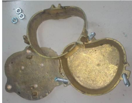
Mufla utilizada para acrilizar los disco de cera.
