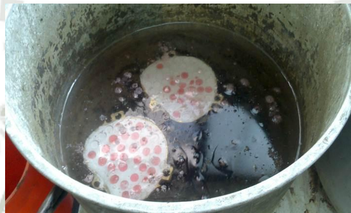
Ebullición de los discos de cera para elaborar un molde
