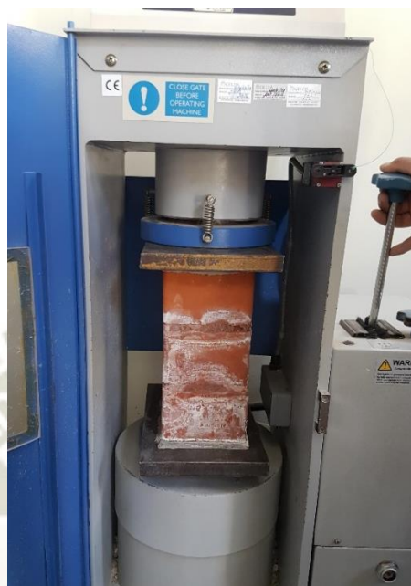
Figura 34. Ejecución de ensayo de compresión a muestras de albañilería.
