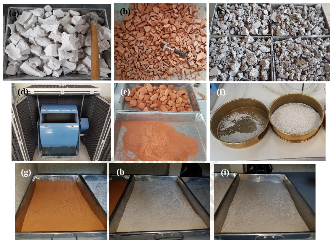
Figura 7. Adecuación preliminar de los materiales precursores: (a) rajas de Ignimbrita, (b) ladrillo de demolición, (c) mortero de demolición, (d) equipo de trituración, (e) ladrillo triturado, (f) tamizado de ignimbrita a 106 micras (g) ladrillo molido y tamizado, (h) ignimbrita molido y tamizado y (i) mortero molido y tamizado.
