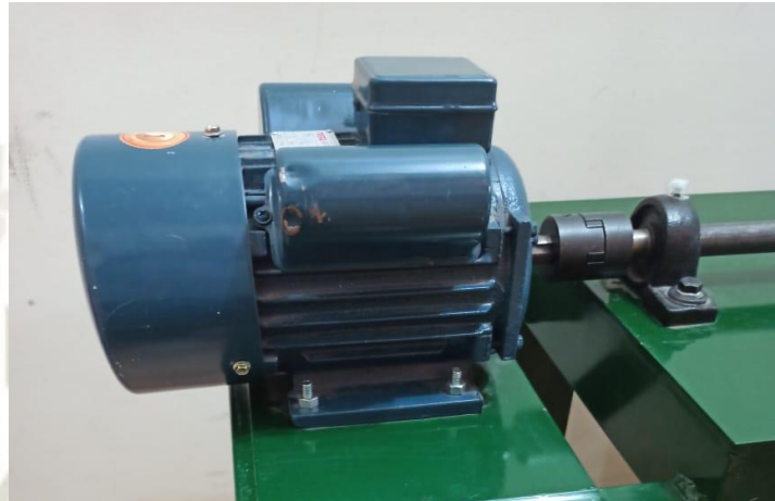
Figura 3.29 Ensamble de motor eléctrico, acople y eje conductor
