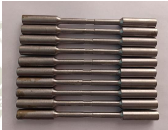
Figura 4.27 Probetas con ranura de fondo plano
