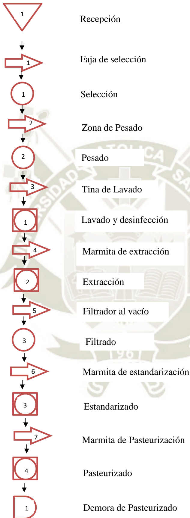
DIAGRAMA N°5: Diagrama de Proceso Lógico
