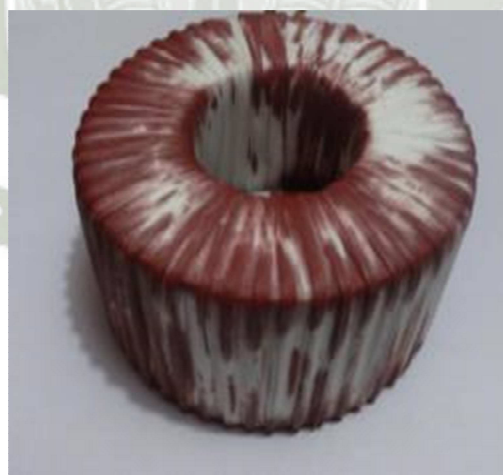
Fig. 29 Protección de la bobina con una capa de cinta de algodón y una mano ligera de barniz aislante
