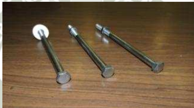
Fig. 34 Pernos pasantes para fijación de las bobinas
