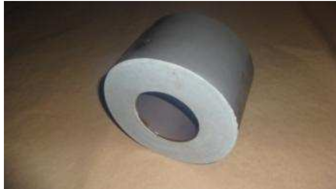
Fig. 21 Núcleo con las tapas laterales de PRESPAN instaladas
