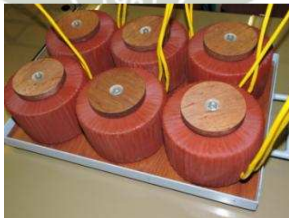
Fig. 38 Fijación completa de los seis inductores
