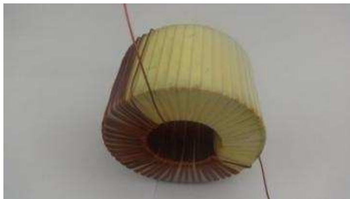
Fig. 27 Núcleo toroidal parcialmente embobinado
