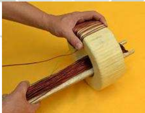
Fig. 25 Proceso de inicio de embobinado del núcleo con alambre esmaltado
