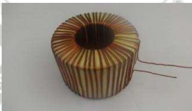
Fig. 28 Núcleo toroidal con la bobina completa
