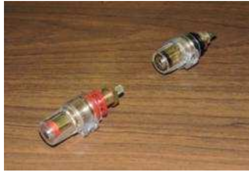
Fig. 39 Conectores industriales para conexión de los terminales de las bobinas
