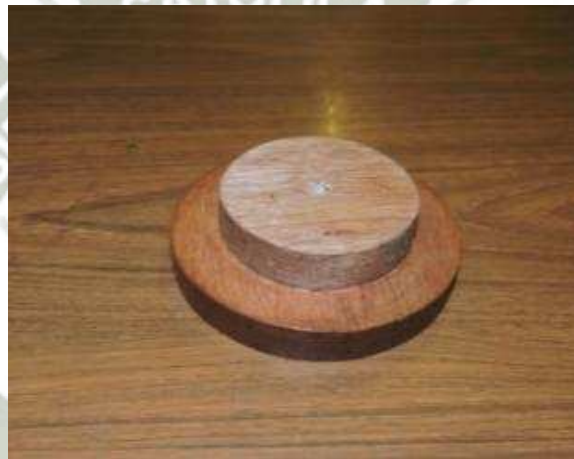
Fig. 37 Elemento de fijación de madera para cada uno de los inductores
