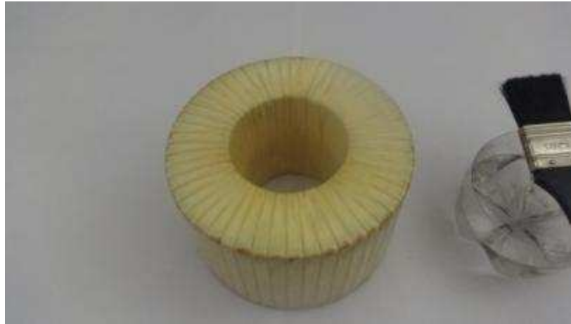
Fig. 24 Impregnado del núcleo aislado con resina sintética MEC
