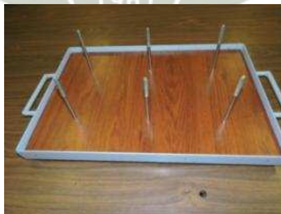
Fig. 35 Perfil y base con los pernos de fijación instalados
