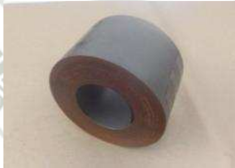
Fig. 19 Núcleo toroidal formado para el área diseñada( 4 cm. De espesor)
