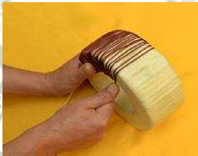
Fig. 25 Proceso de inicio de embobinado del núcleo con alambre esmaltado
