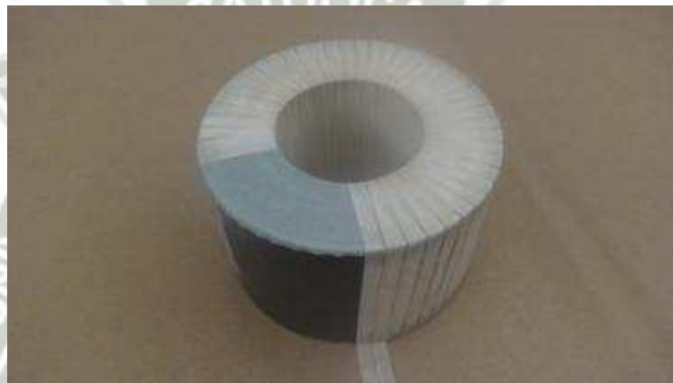
Fig. 22 Aislamiento del nucleo toroidal con cinta de vidrio virgen
