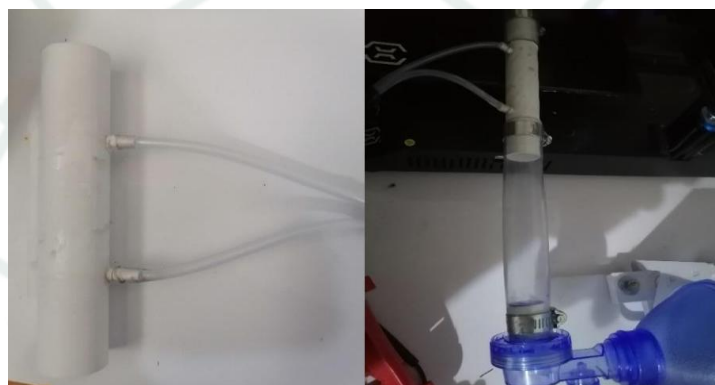
Figura 57 Empalme del tubo de Venturi
