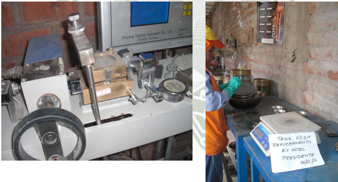
FIGURA 4.86 – CORTE DIRECTO Y GRANULOMETRÍA
