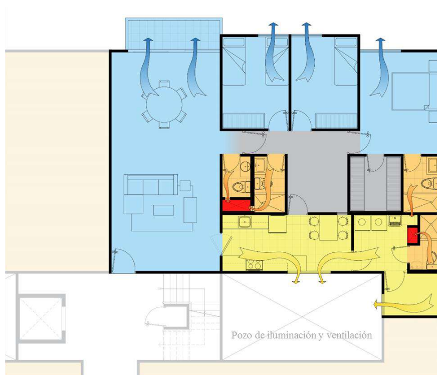
Ventilación Natural Unidad Villa Verde I
