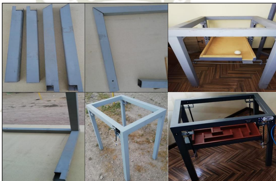
Figura 76. Estructura del tablero didáctico.
