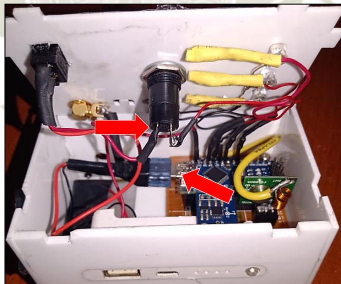
Figura 108. Colisión parada de emergencia con conector.
