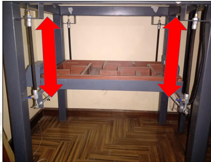
Figura 114. Contracciones de los músculos neumáticos.
