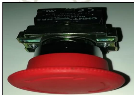
Figura 56. Parada de emergencia.
