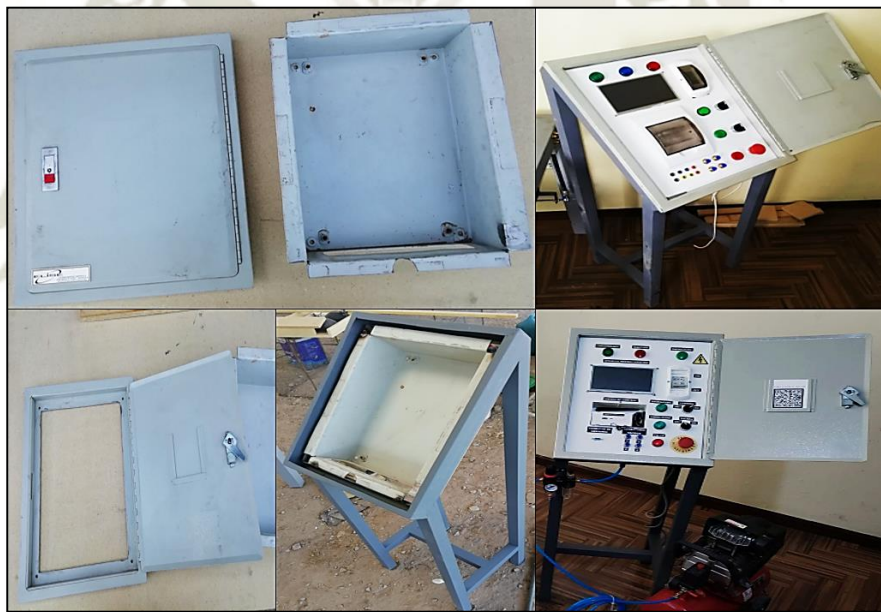
Figura 83. Estructura y panel de control.
