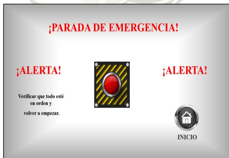
Figura 129. Pantalla de parada de emergencia.
