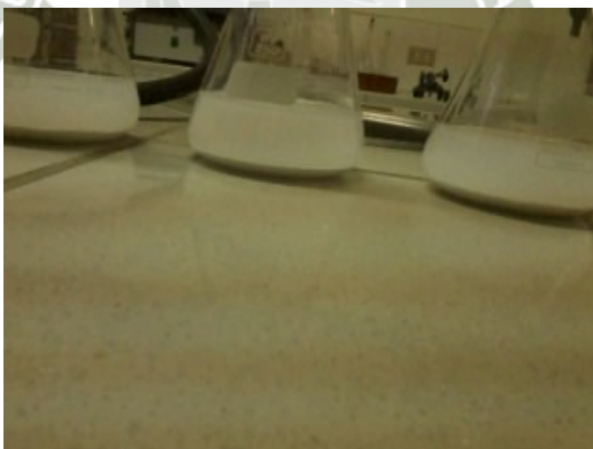
Figura 15: Precipitación en muestras tras adición de acetato neutro de plomo
