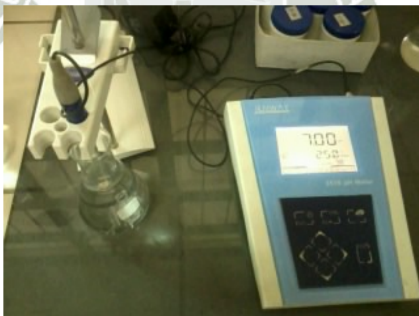
Figura 18: Nivelación de pH del filtrado
