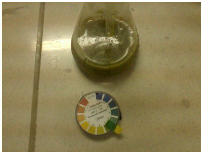
Figura 22: Medición del pH del rumen bovino, se observa un pH de 7.
