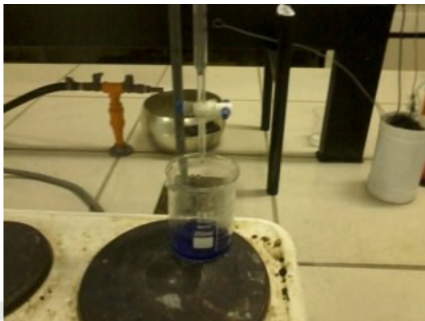
Figura 20: Titulación del licor de Fehling
