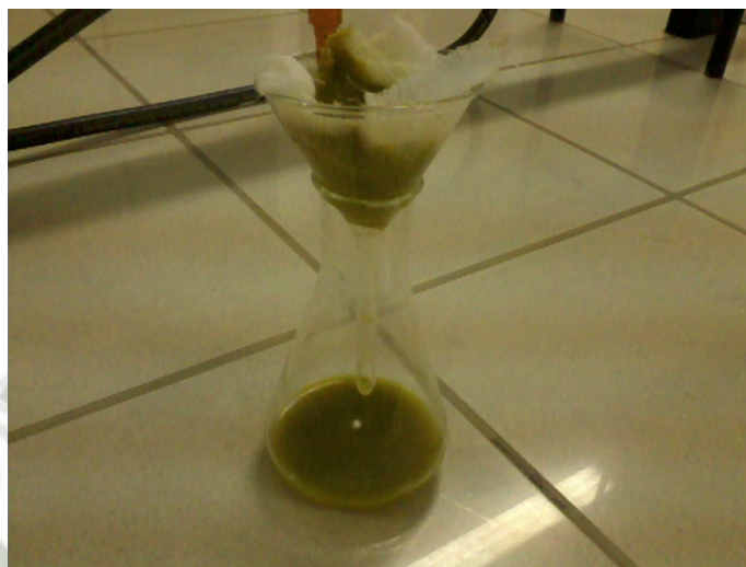
Figura 7: Pre-tratamiento de rumen bovino mediante filtrado.
