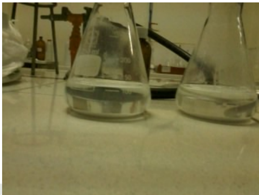
Figura 17: Apariencia del filtrado tras adición del oxalato de potasio
