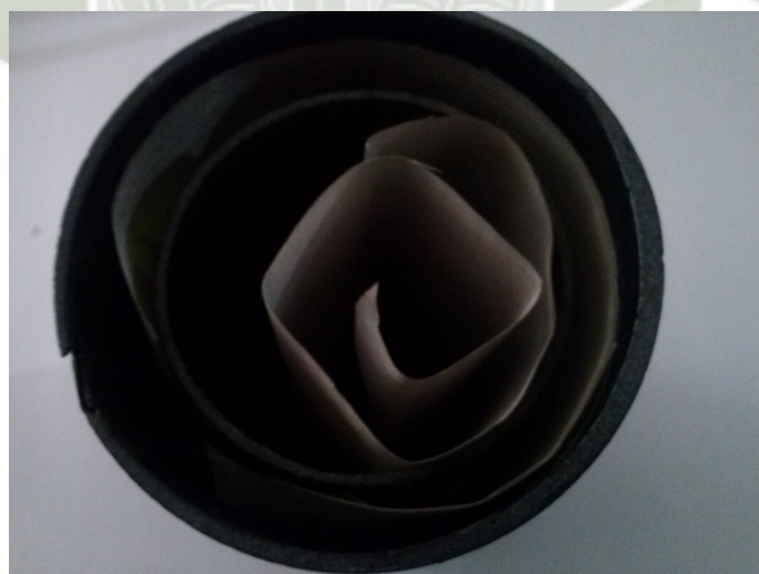
Figura 10: Cámaras de la celda de combustible microbiana mostrando los electrodos colocados.
