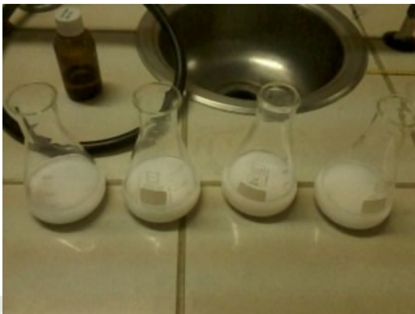
Figura 14: Muestras tras adición de acetato neutro de plomo
