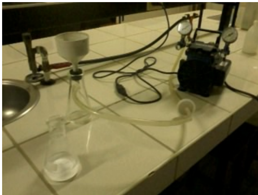
Figura 16: Filtración tras precipitación con oxalato de potasio
