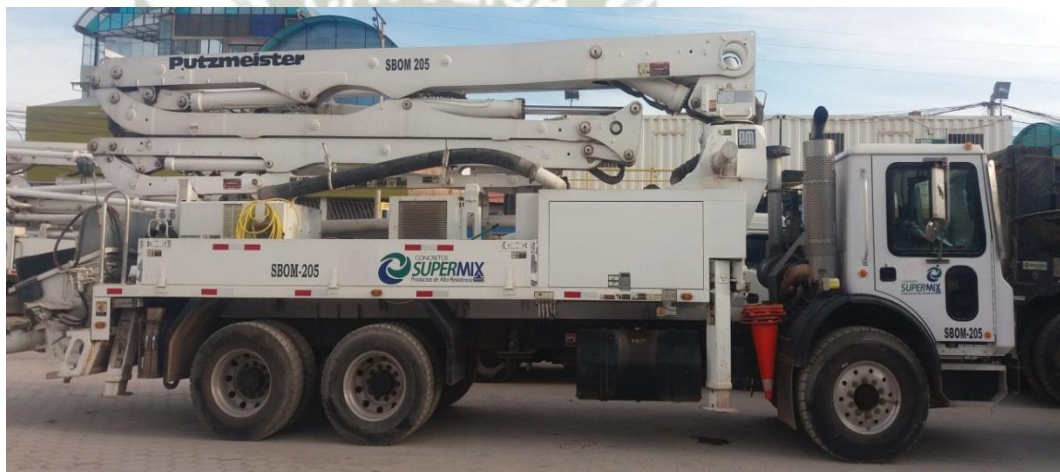
Figura N°18: Camión bomba telescópica
