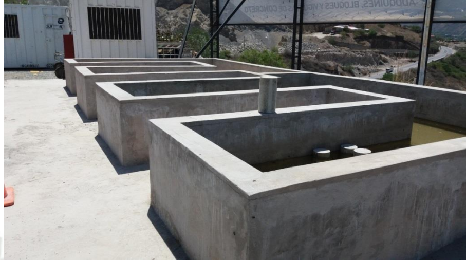
Figura N°8: Poza de curado de probetas
