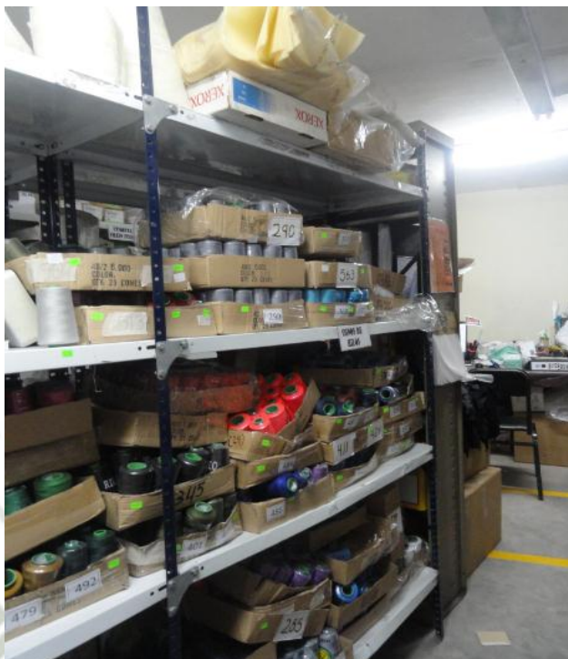
Figura 4.10. Estantería dañada por el peso de materiales
