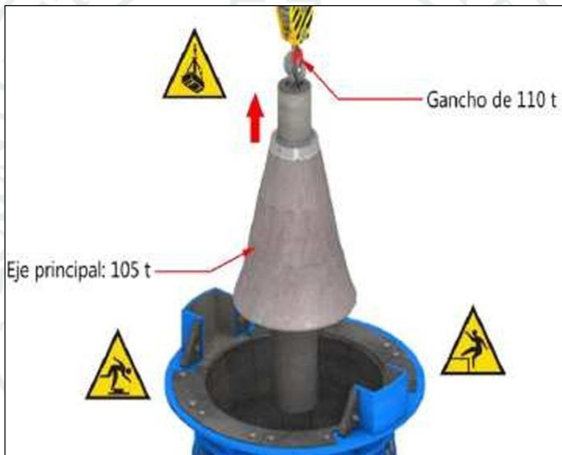
Figura 12. Izaje del eje principal (main shaft)
