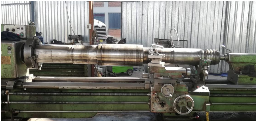
Figura 4.6: Montaje de eje sobre torno. - Elaboración propia
