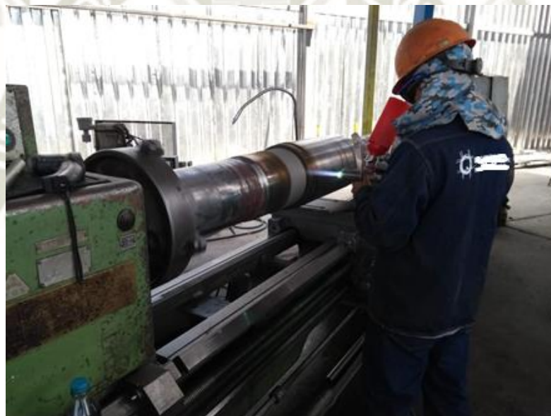
Figura 4.18: Aplicación de Metaceram 29012. - Elaboración propia
