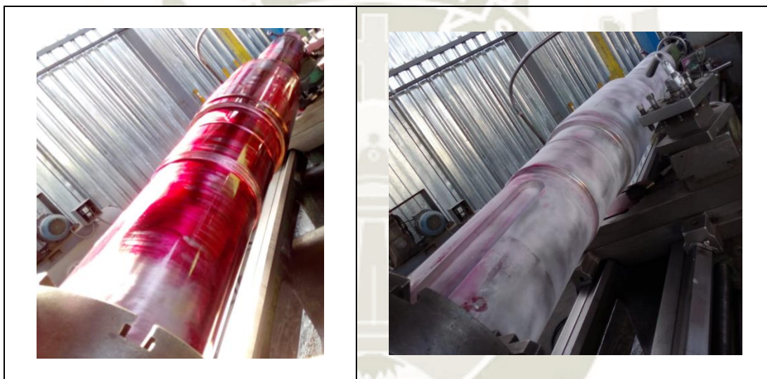
Figura 4.5: Inspección NDT por líquidos penetrantes. - Elaboración propia
