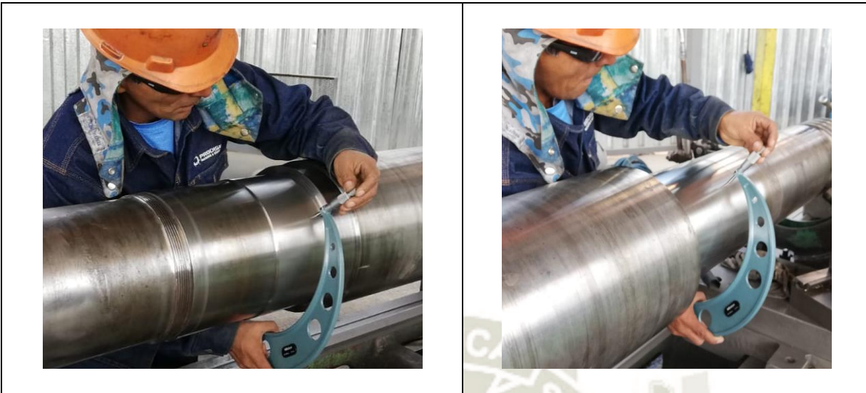
Figura 4.20: Control dimensional final. - Elaboración propia
