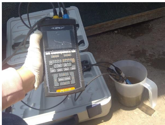
Figura N° 28 Medición de la Conductividad
