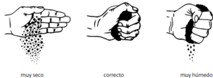
Figura N° 13 Medición de la humedad mediante la técnica del “puño cerrado”
