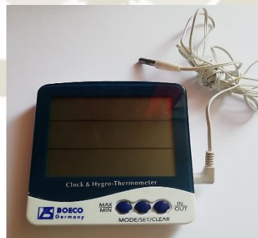
Figura N° 11 Equipo utilizado para medir la temperatura de la mezcla
