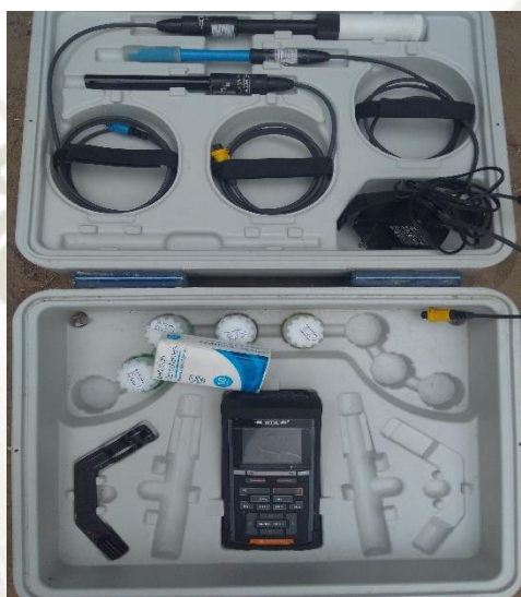
Figura N° 12 Equipo utilizado para medir el pH de la mezcla
