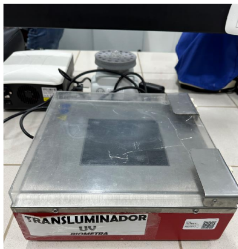
Imagen 2 Transiluminador para visualización de geles de agarosa.
