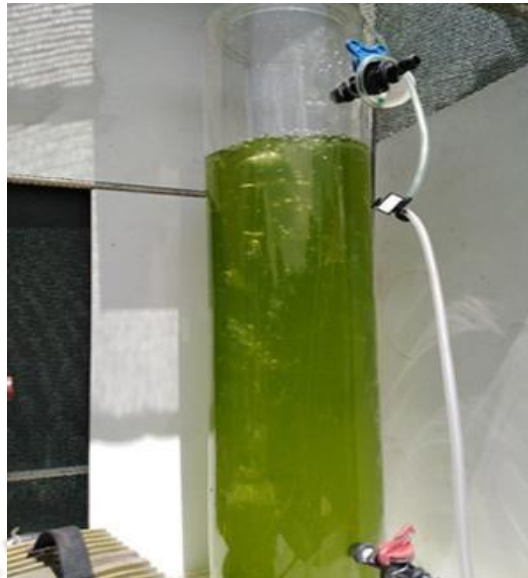
Figura 9. Sistema de fotobiorreactor en funcionamiento
