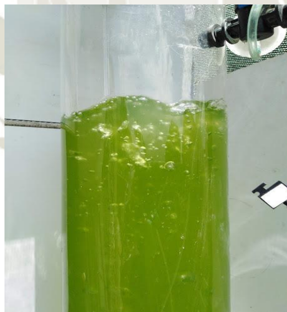
Fig. 8: Escalamiento del cultivo en fotobiorreactor
