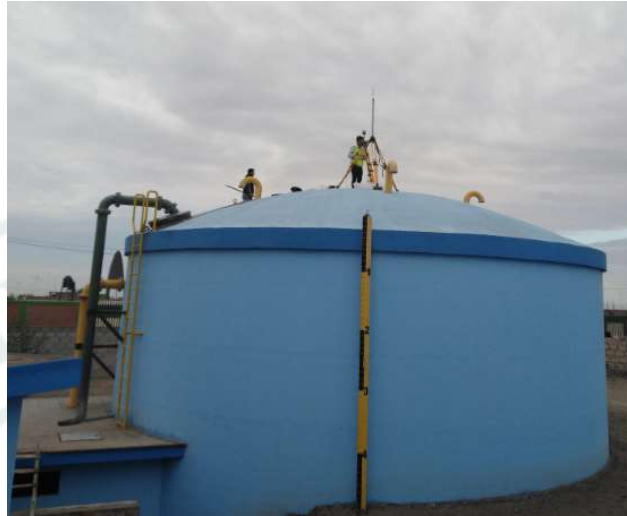
Figura 4: Base en función a un punto topográfico de orden “C” para la geometría de la red
